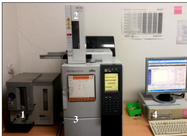
SLIKA 3.2. GC sustav: 1 – generator vodika, 2 – sustav za automatsko injektiranje, 3 – plinski kromatograf, 4 – PC
