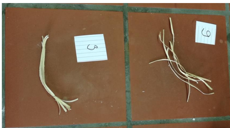
Slika 12. Pripremljeni snopovi duljine 10 cm
