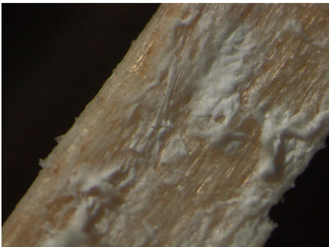
Slika 24. Drvce tretirano u dva ciklusa i snimano stereo mikroskopom
