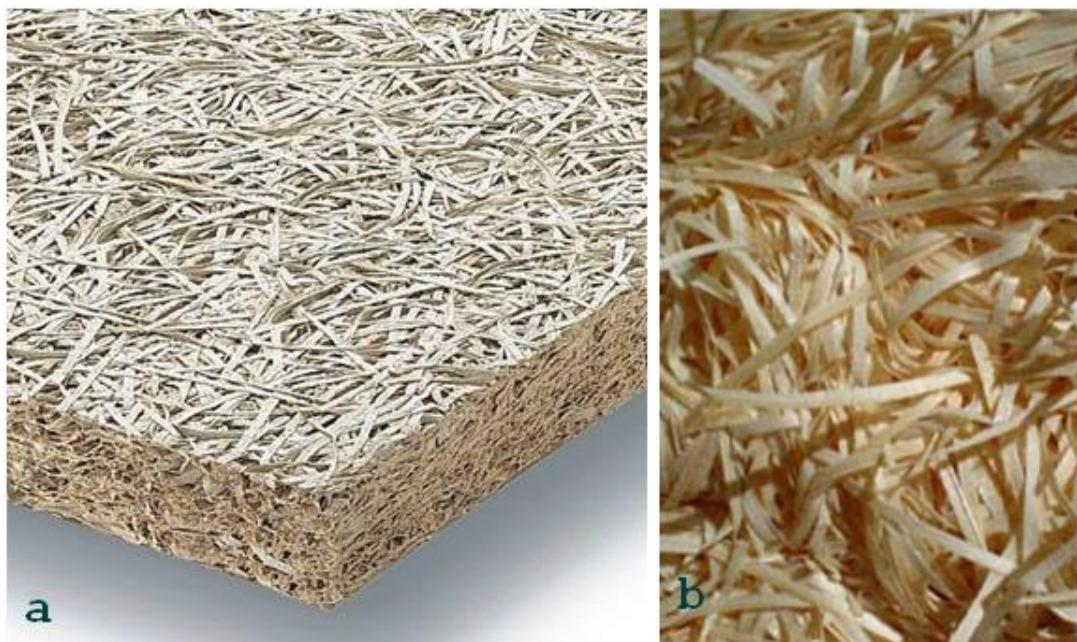
Slika 6. Drvo-cementni kompozit<sup>16</sup> (a) i drvena vuna (b)<sup>15</sup>
