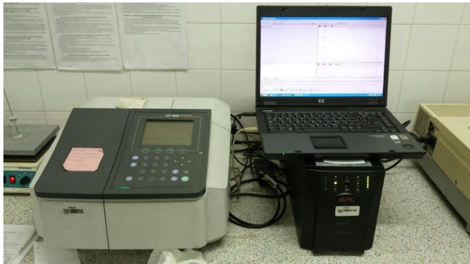
**Slika 3.9. Spektrofotometar**
