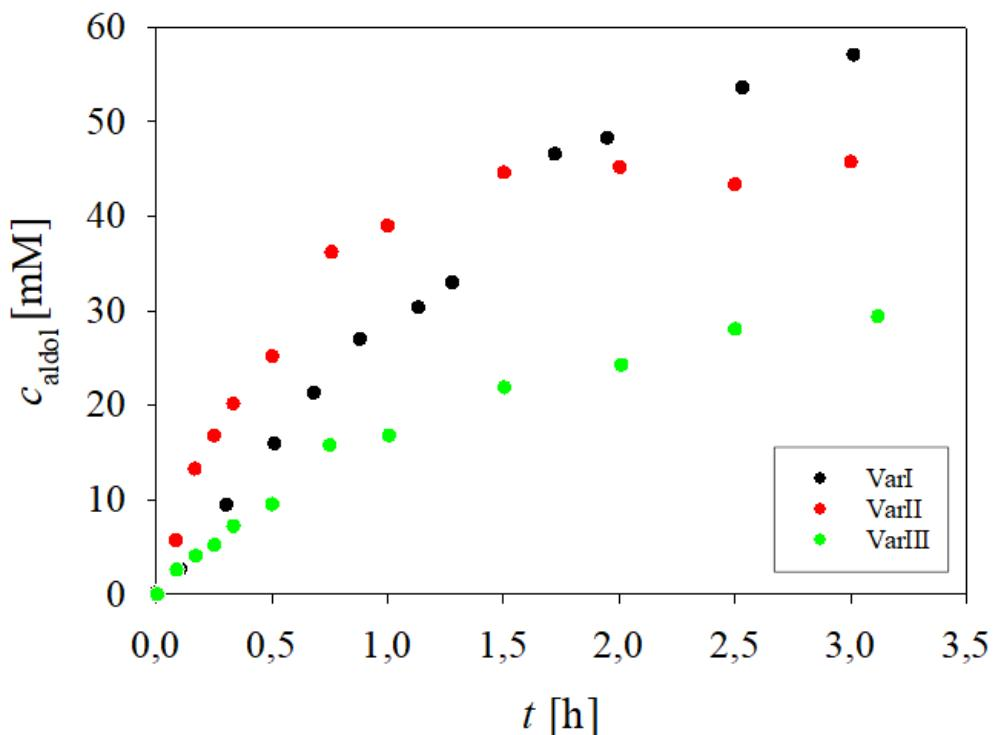
**Slika 4.8.** Utjecaj koncentracije enzima FSA VarI, VarII i VarIII na nastajanje aldola u kotlastom reaktoru ( $25^{\circ}\text{C}$ ,  $50\text{ mM}$  pufer,  $\gamma_{\text{FSA}} = 5\text{ mg mL}^{-1}$ ,  $c_{\text{propanal}} = 100\text{ mM}$ ,  $c_{\text{formaldehid}} = 100\text{ mM}$ ).
