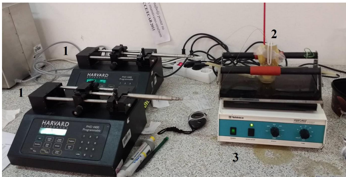
Slika 3.3. Aparatura za provođenje eksperimenta u kotlastom reaktoru s dotokom koja se sastoji od: 1) klipnih pumpi, 2) tikvica, 3) tresilica
