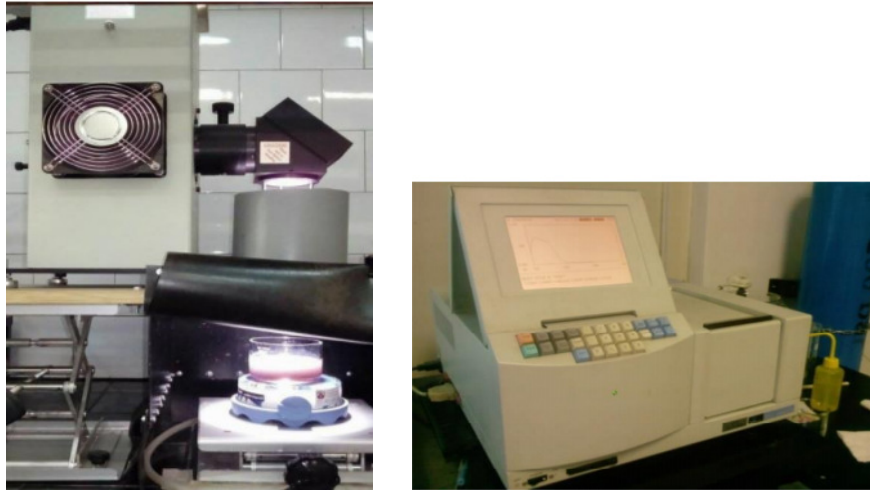
Slika 3.9. Oriel Newport (Osram XBO 450W Xe lampa), UV/VIS spektrofotometar
