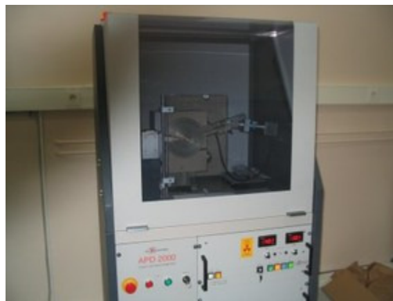
Slika 3.6. Difraktometar ItalStructures APD 2000
