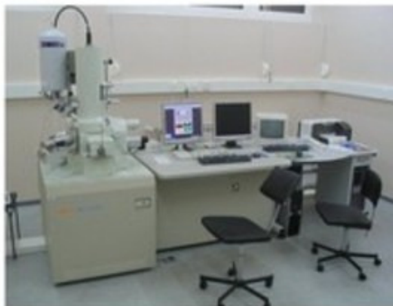
Slika 3.7. Pretražni elektronski mikroskop, JEOL (FE-SEM, model JSM-7000F)
