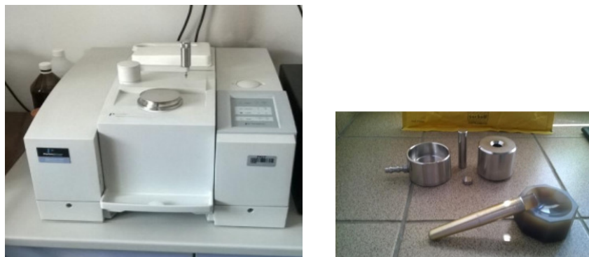
Slika 3.4. Ftir spektrofotometar, Spectrum One, Perkin Elmer, pribor za pripravu pastila
