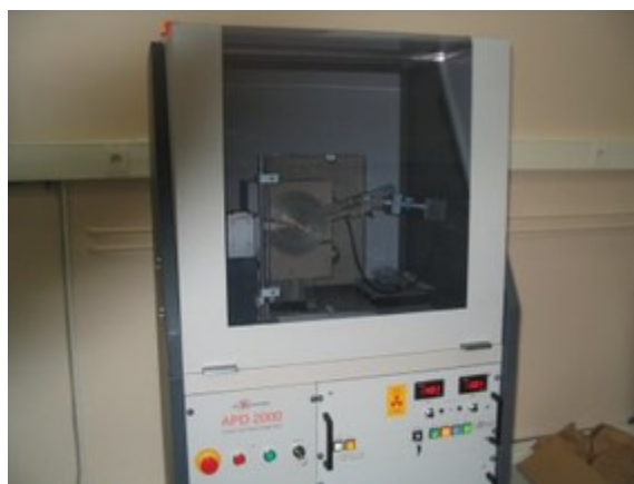
Slika 3.6. Difraktometar ItalStructures APD 2000
