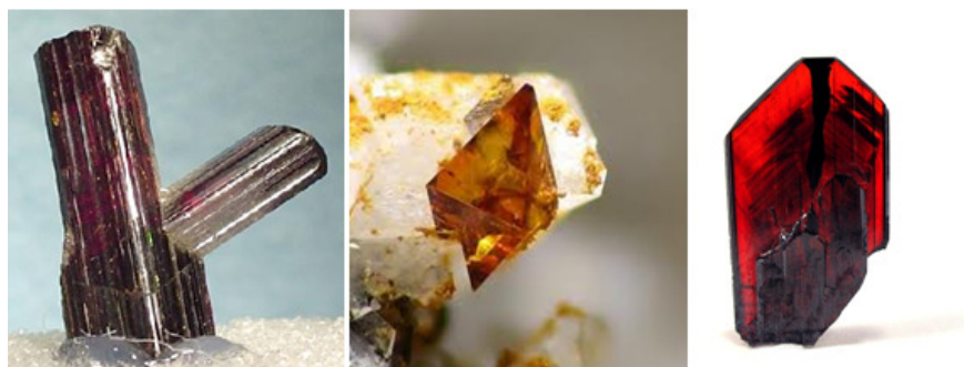
Slika 2.8. Polimorfne modifikacije TiO_2 (s lijeva na desno: rutil, anatas, brukit)
