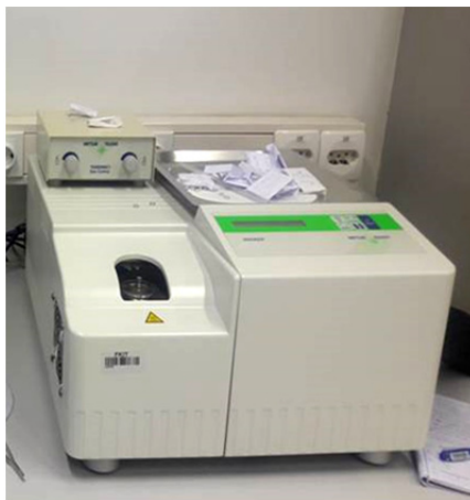
Slika 30. Diferencijalni pretražni kalorimetar Mettler toledo DSC 823e
