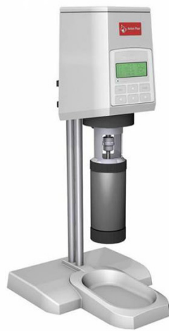
Slika 29. Reometar Anton Paar RheolabQC 50
