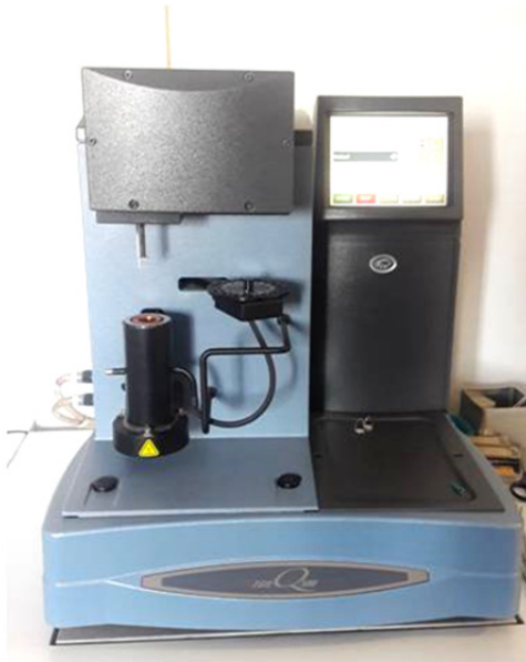
Slika 31. TGA uređaj tvrtke TA Instruments
