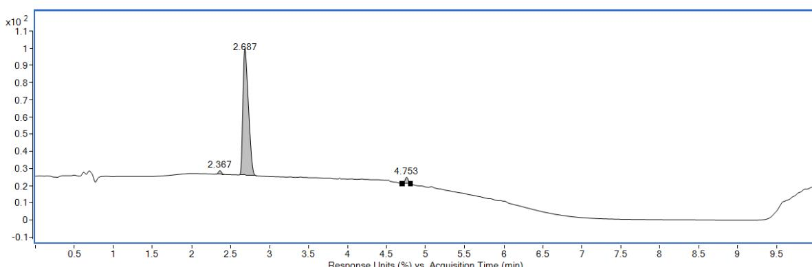
**Slika 4.7.** Kromatogram netretiranog lidokaina (konc. 1 mg/mL)
