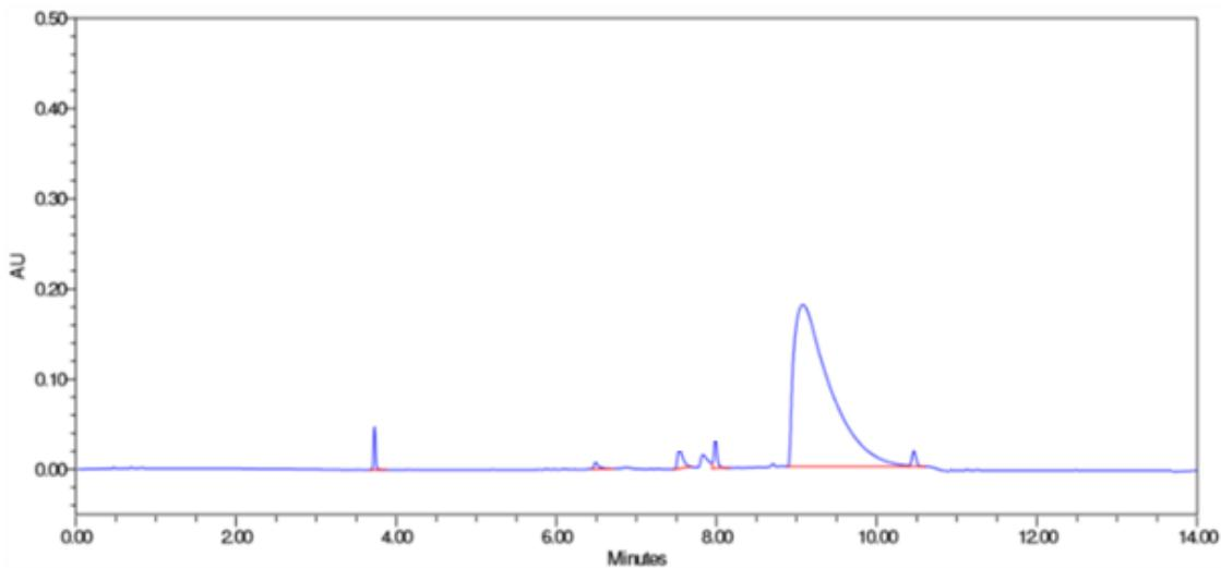
**Slika 4.1.** Kromatogram lidokaina na Phenyl kromatografskoj koloni
