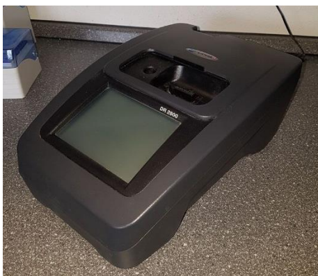
Slika 13. Spektrofotometra marke DR 2800, Hach Lange
