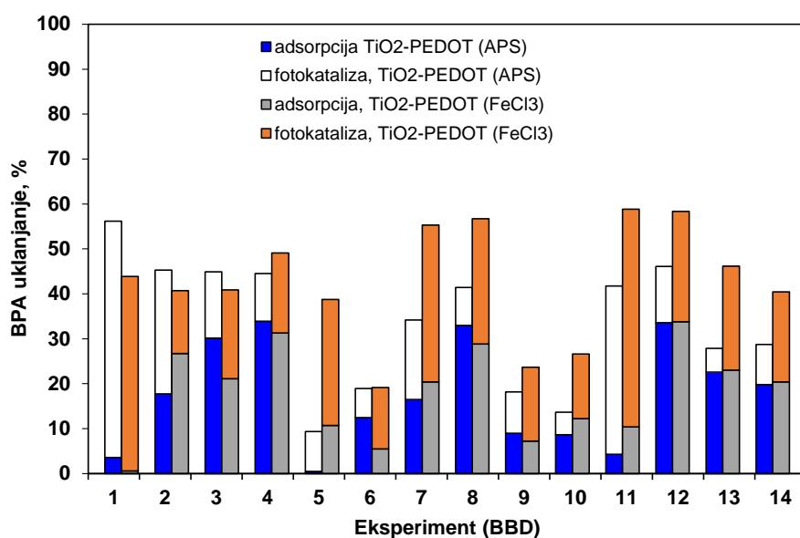
**Slika 4.6.** Usporedba uklanjanja BPA uzorcima PEDOT/TiO<sub>2</sub>(APS) i PEDOT/TiO<sub>2</sub>(FeCl<sub>3</sub>) tijekom adsorpcije u mraku i fotokatalize pod simuliranim sunčevim zračenjem
