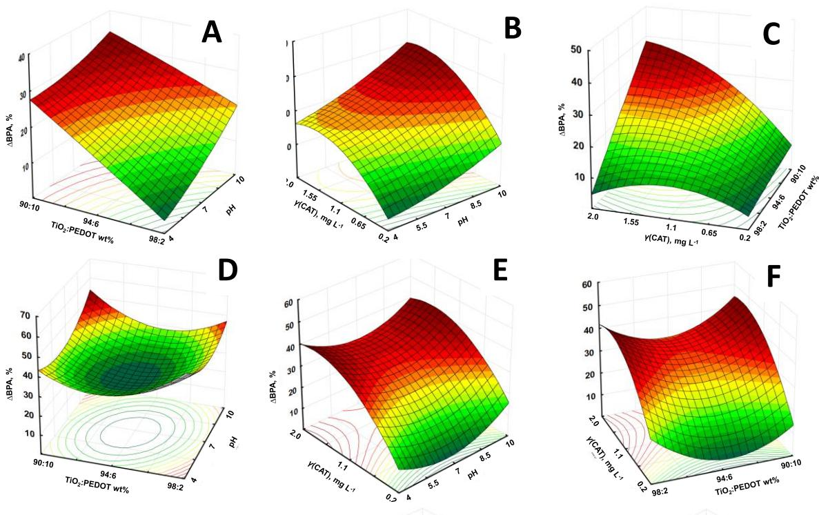
**Slika 4.7.** 3D odzivne površine i konturni dijagrami koji pokazuju efekte međusobne interakcije početnog pH i udjela PEDOT-a (A i D), pH i  $\gamma$ (katalizatora) (B i E), i udjela PEDOT-a i  $\gamma$ (katalizatora) (C i F) na uklanjanje BPA tijekom adsorpcije u mraku (gornji red) i ukupnog procesa fotokatalize (donji red) uz uzorce  $TiO_2$ -PEDOT (APS)
