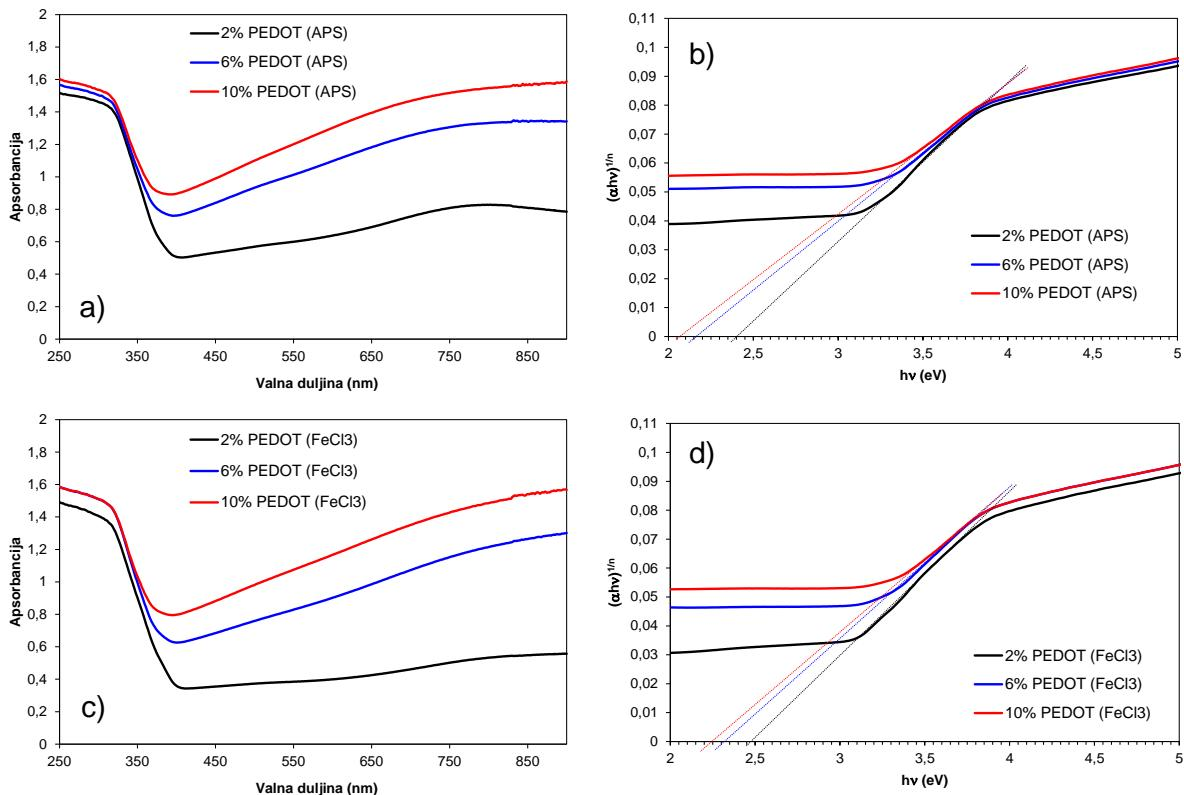
**Slika 4.4.** Difuzni reflektacijski spektri a)  $\text{TiO}_2$ -PEDOT(APS) i c)  $\text{TiO}_2$ -PEDOT ( $\text{FeCl}_3$ ) kompozita s različitim udjelom PEDOT-a te pripadajući Tauc-ovi grafovi Kubelka-Munk funkcija v. energija fotona (b i d)
