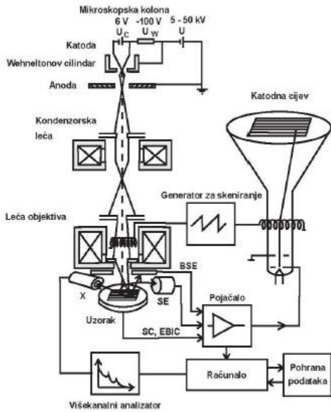
**Slika 2.13.** Shematski prikaz rada SEM uređaja [17]
