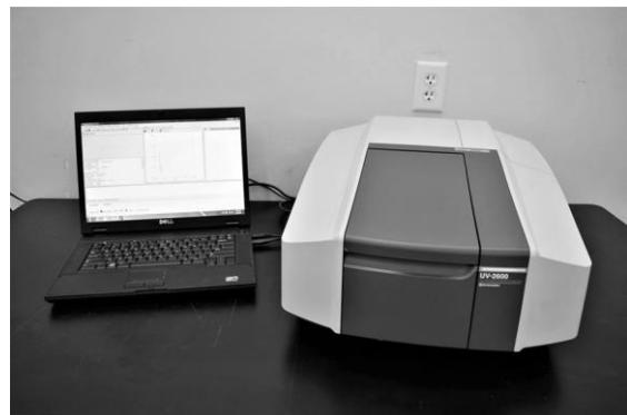
**Slika 3.4.** UV/Vis spektrofotometar UV-2600, *Shimadzu*
