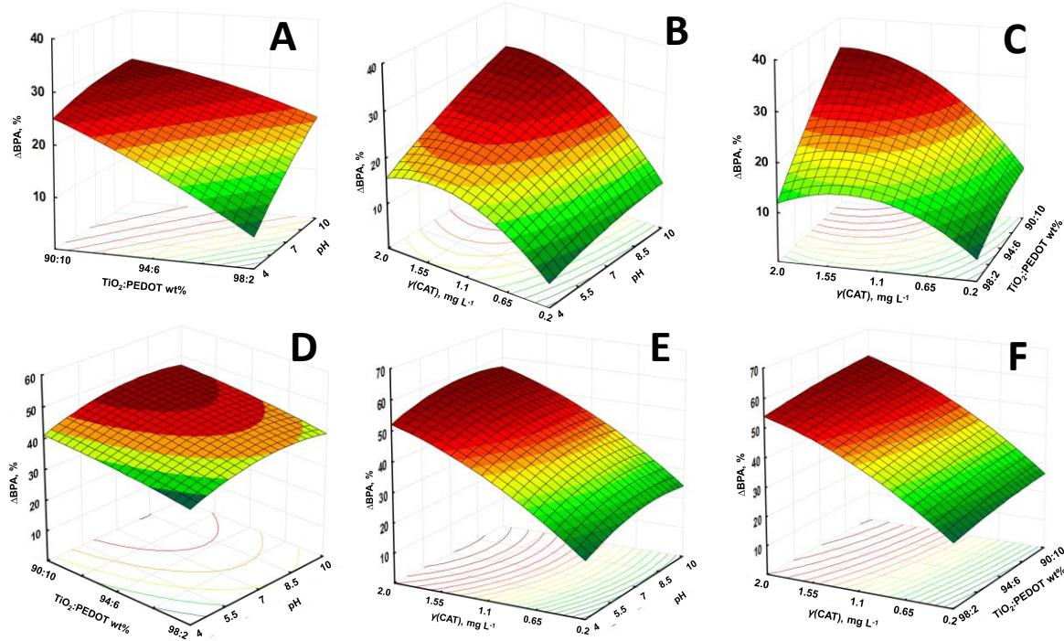
**Slika 4.8.** 3D odzivne površine i konturni dijagrami koji pokazuju efekte međusobne interakcije početnog pH i udjela PEDOT-a (A i D), pH i  $\gamma$ (katalizatora) (B i E), i udjela PEDOT-a i  $\gamma$ (katalizatora) (C i F) na uklanjanje BPA tijekom adsorpcije u mraku (gornji red) i ukupnog procesa fotokatalize (donji red) uz uzorke TiO<sub>2</sub>-PEDOT (FeCl<sub>3</sub>)
