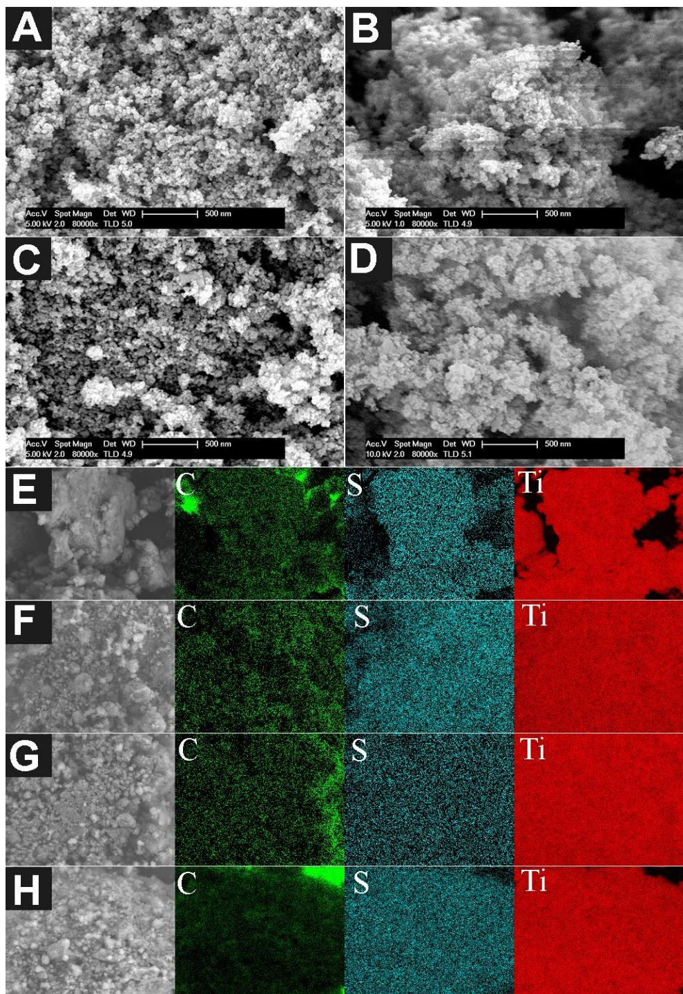
**Slika 4.3.**SEM slike TiO<sub>2</sub>-PEDOT kompozita: a) PEDOT 2% (APS), b) PEDOT 2% (FeCl<sub>3</sub>), c) PEDOT 10 % (APS) i d) PEDOT 10% (FeCl<sub>3</sub>), i njihovo pripadajuće EDX mapiranje (e, f, g i h)
