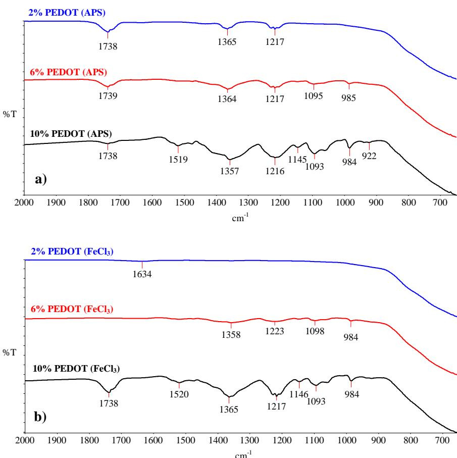
Slika 4.1. FTIR spektri sintetiziranih  $\text{TiO}_2$ -PEDOT kompositnih fotokatalizatora pripremljenih s a) APS oksidansom i b)  $\text{FeCl}_3$  oksidansom
