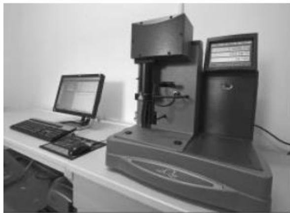
**Slika 3.2.** Termogravimetar Q500, *TA Instruments*
