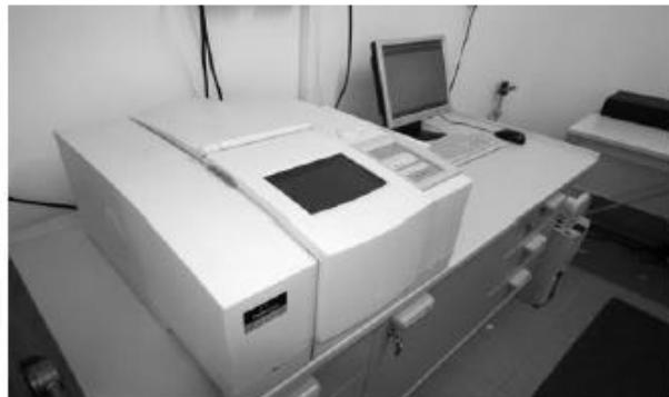
**Slika 3.1.** FTIR spektrofotometar Spectrum One, *Perkin Elmer*
