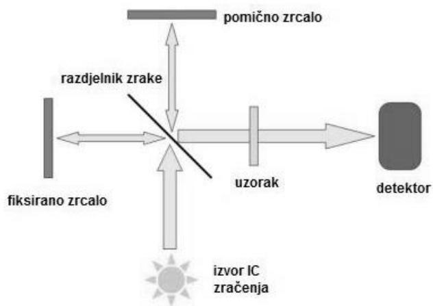
Slika 2.11. Shematski prikaz rada spektrofotometra s Fourierovom transformacijom
