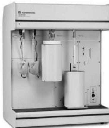
**Slika 3.5.** Uređaj za plinsku adsorpcijsko-desorpcijsku analizuGemini 2380, *Micromeritics*
