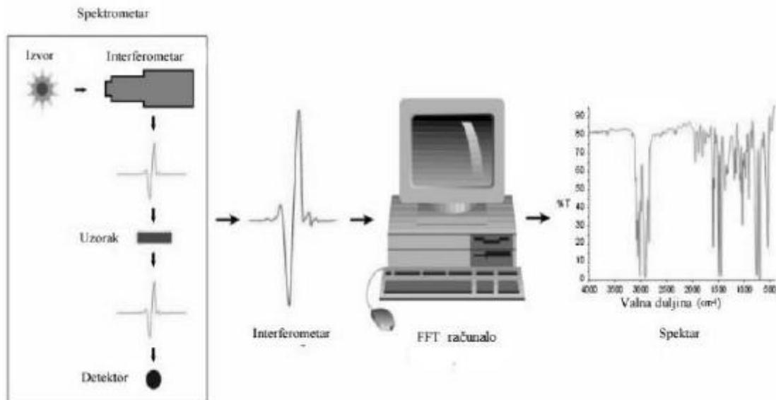
**Slika 2.12.** Princip rada FTIR spektroskopije
