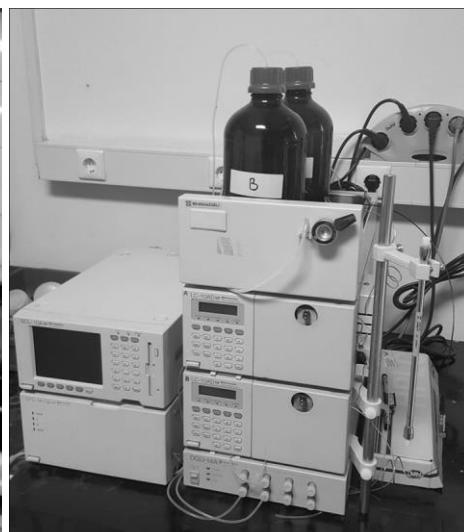
**Slika 3.7.** Tekućinski kromatograf visoke učinkovitosti LC-10, *Shimadzu*
