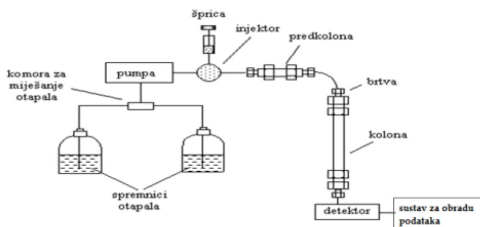
Slika 3.8. Shematski prikaz HPLC uređaja
