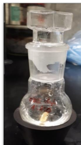
Slika 5. Aparatura za provedbu procesa sinteze eutektičkih otapala
