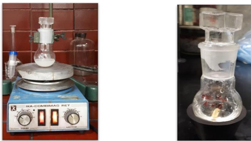
**Slika 5.** Aparatura za provedbu procesa sinteze eutektičkih otapala
