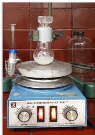
Slika 5. Aparatura za provedbu procesa sinteze eutektičkih otapala
