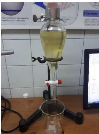
Slika 10. Separacija biodizela i glicerola u lijevku za odjeljivanje
