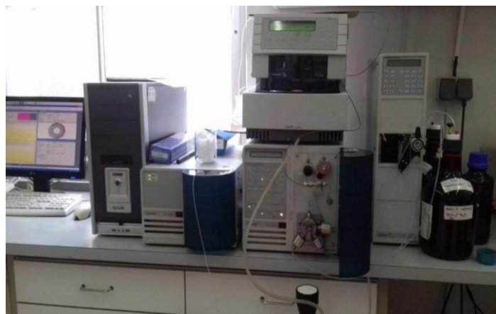
Slika 12. Tekućinski kromatograf visoke djelotvornosti, Varian ProStar 500, s detektorom s nizom dioda (HPLC - DAD)
