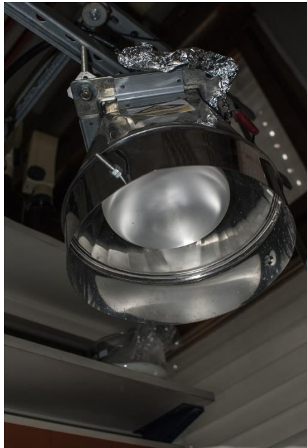
Slika 18. Svjetilka sa zračenjem sličnim Sunčevom (Osram VitalLux)
