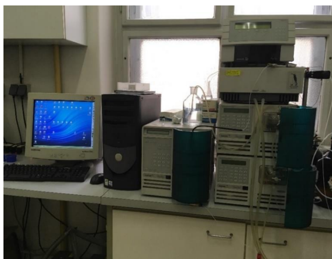
Slika 13. Tekućinski kromatograf visoke djelotvornosti, Varian ProStar 363, s fluorescentnim detektorom (HPLC - FLD)
