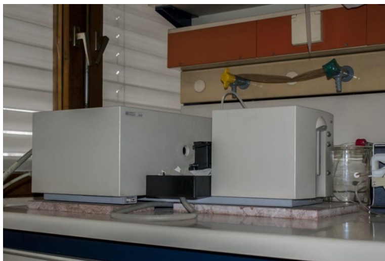
Slika 19. UV-Vis HP 8453 spektrofotometar
