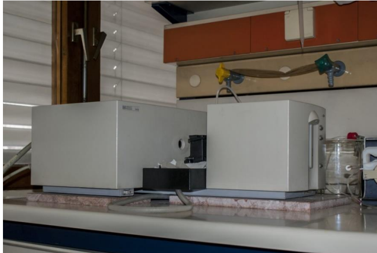
Slika 19. UV-Vis HP 8453 spektrofotometar
