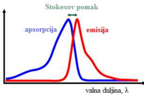
Slika 6. Prikaz apsorpcijskog i fluorescencijskog spektra [8].
