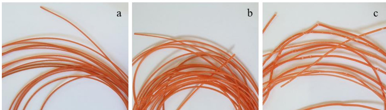
Slika 16. Dobiveni filamenti: a) PVA FF A 10% 150, b) PVA FF A 10% 160, c) PVA FF A 10% 170
