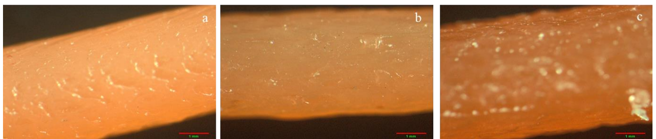
Slika 21. Mikrografije filamenata: a) PVA FF A 10% 150, b) PVA FF A 10% 160, c) PVA FF A 10% 170 pri uvećanju 4x
