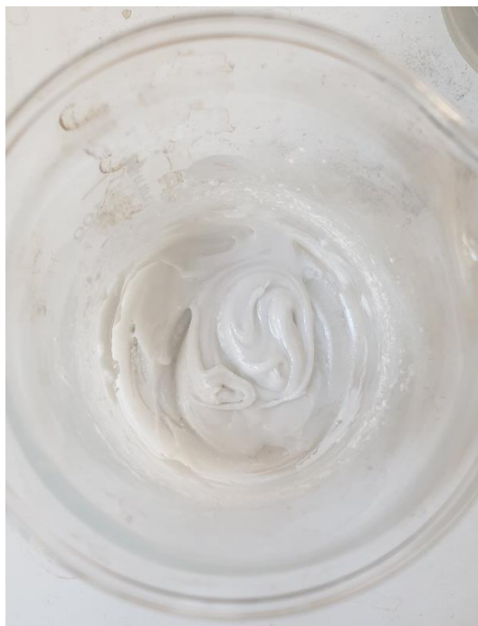
Slika 12. Rastaljena mješavina PEG-a i dronedaron-hidroklorida
