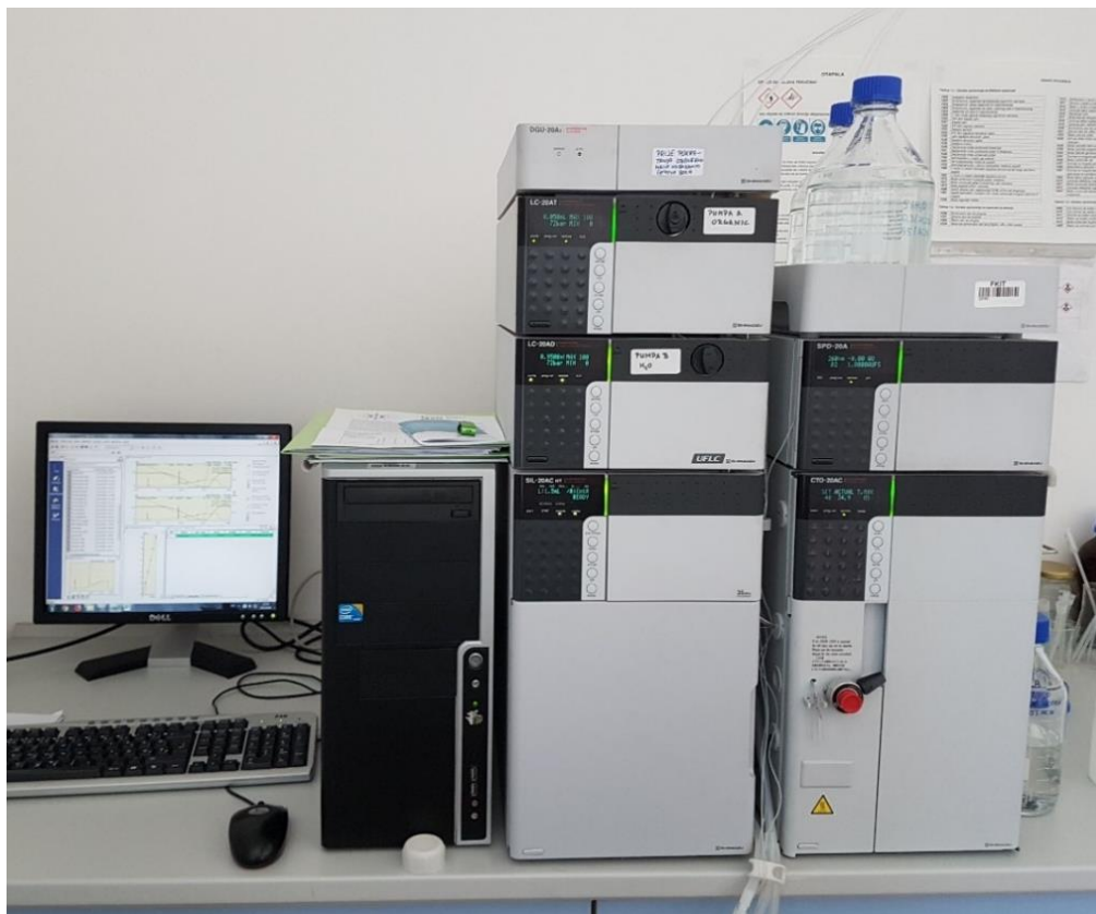
Slika 12. HPLC uređaj s pripadajućom računalnom podrškom
