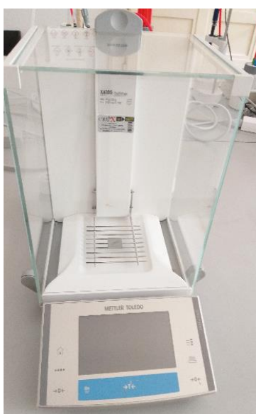
Slika 2. Slika analitičke vage korištene za vaganje analita
