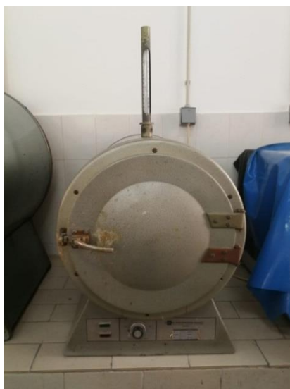
Slika 4. Sušionik Instrumentaria korišten za termalnu razgradnju
