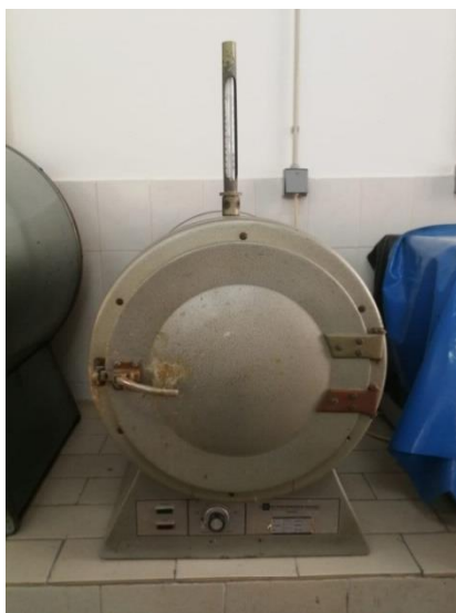
Slika 4. Sušionik Instrumentaria korišten za termalnu razgradnju
