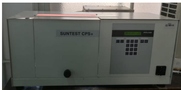
Slika 5. Atlas Suntest CPS+ fotolizer korišten za UV/VIS razgradnju
