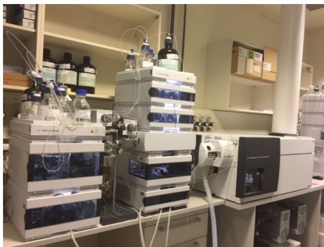
Slika 6. Tekućinski kromatograf ultravisoke djelotvornosti povezan sa spektrometrom masa visoke razlučivosti (2D-UHPLC-QTOF)
