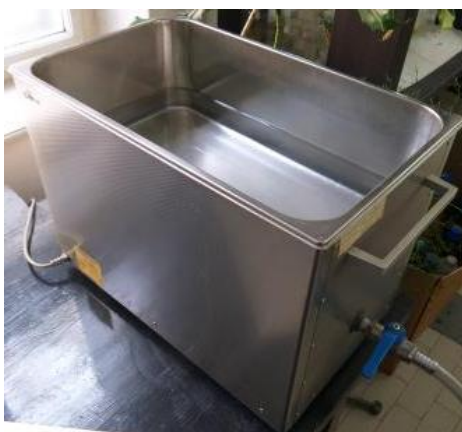
Slika 3. Ultrazvučna kupelj Bandelin Sonorex Digital 10 P korištena za pripremu uzoraka
