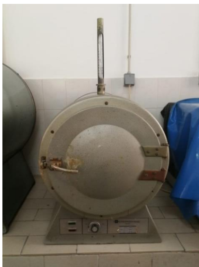
Slika 4. Sušionik Instrumentaria korišten za termalnu razgradnju
