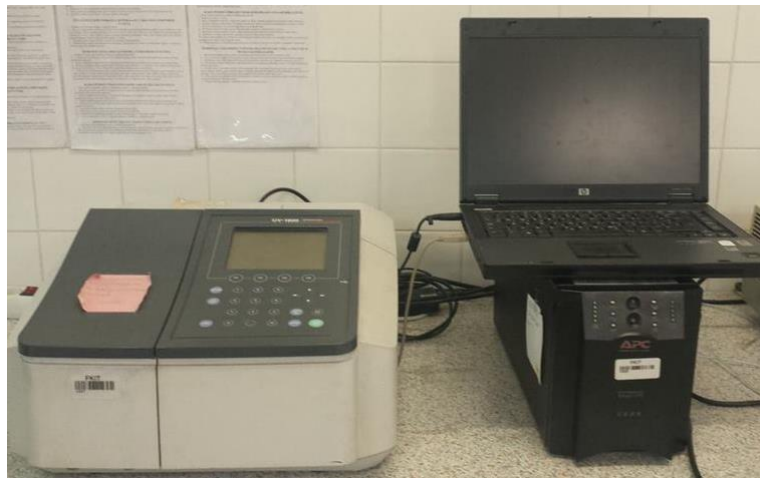
Slika 3.2.4.2. Spektorfotometar Shimadzu UV-1800
