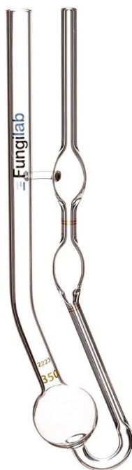
Slika 3.2.5.1. Prikaz Canon-Fenske viskozimetra
