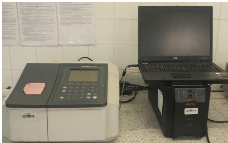
Slika 3.2.4.2. Spektorfotometar Shimadzu UV-1800
