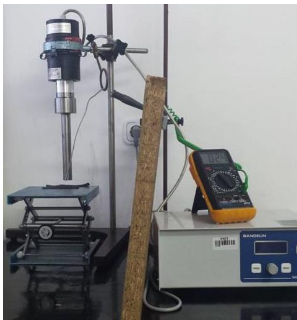
Slika 3.2.2.1. Prikaz aparature za homogenizaciju nanofluida pomoću ultrazvuka
