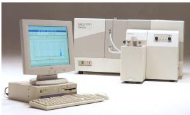
Slika 3-3-6 Čestični analizator Shimadzu SALD-3101
