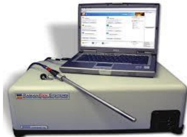
Slika 3-3-2 Raman uređaj za spektroskopiju RAMANRXN SYSTEMS
