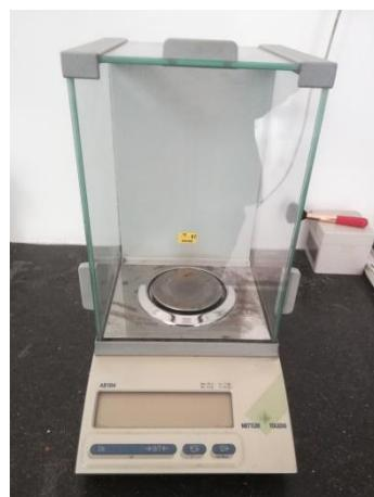
**Slika 17.** Analitička vaga Mettler Toledo AB104
