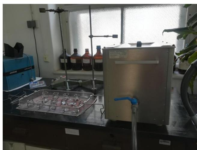
**Slika 18.** Ultrazvučna kupelj SONOREX DIGITAL 10 P, Bandelin, Berlin, Njemačka
