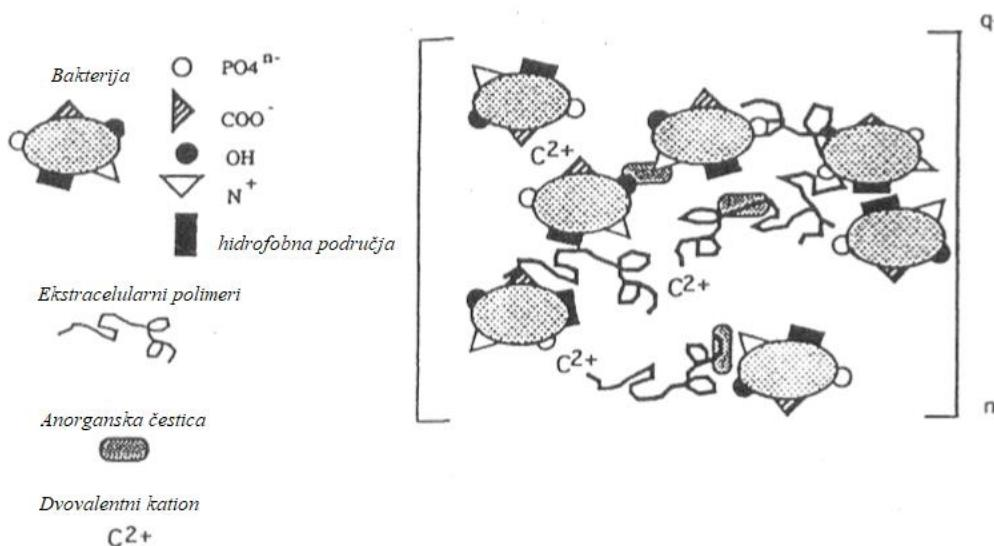
**Slika 2.** Mehanizam flokulacije aktivnog mulja<sup>[5]</sup>
