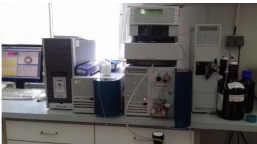
**Slika 21.** Tekućinski kromatograf visoke djelotvornosti, Varian ProStar 500
