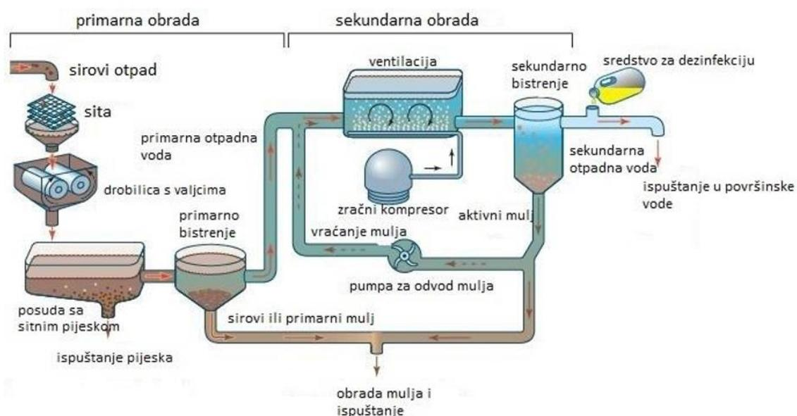
**Slika 4.** Obrada aktivnog mulja<sup>[10]</sup>
