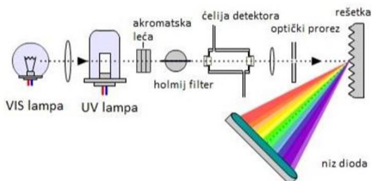
**Slika 16.** Detektor s nizom dioda<sup>[67]</sup>
