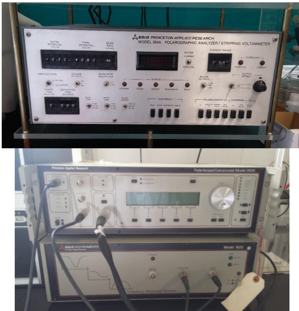
Slika 18. Instrumenti korišteni za snimanje cikličke voltetrije (gore) i impedancije (dolje).
