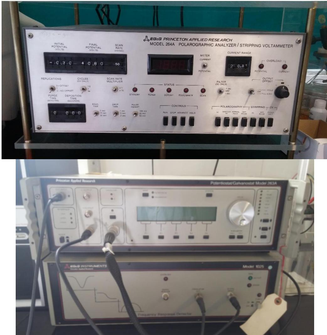
**Slika 18.** Instrumenti korišteni za snimanje cikličke voltametrije (gore) i impedancije (dolje).
