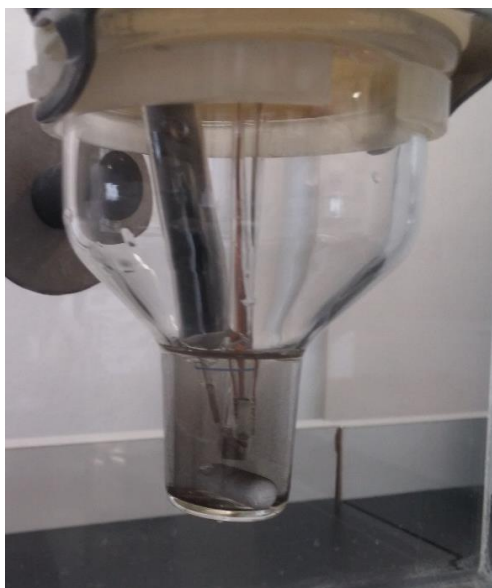
Slika 29. Istaložene nanočestice srebra u BR puferu pH=4.5.
