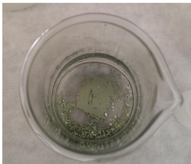
Slika 20. a) Istaložene nanočestice srebra (gore); b) uzorak dobiven nakon sušenja (dolje).
