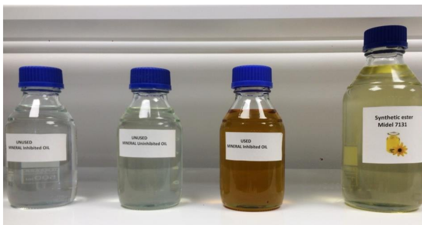
Slika 3.1.1. Prikaz transformatorskog ulja: nekorišteno inhibirano ulje, nekorišteno neinhibirano ulje, korišteno inhibirano ulje i sintetski ester Midel ® 7131
