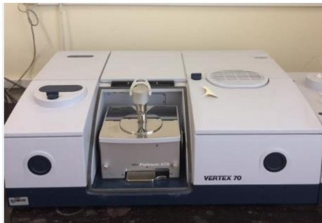
Slika 3.3.2.2. FTIR spektrometar
