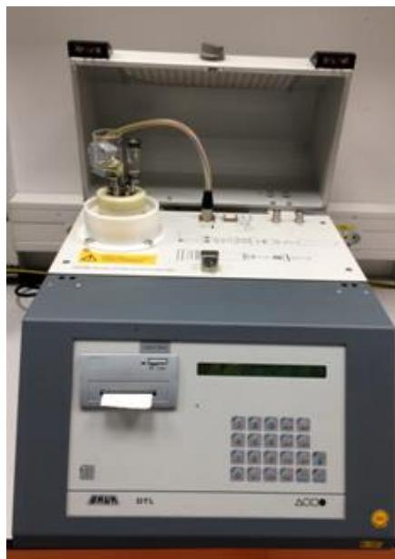
Slika 3.3.7.2. Uredaj za mjerjenje faktora dielektričnog gubitka i specifičnog otpora
