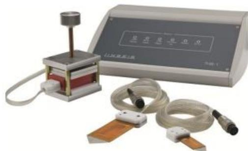
Slika 3.3.4.1. Uredaj za mjerjenje toplinske vodljivosti<sup>[12]</sup>
