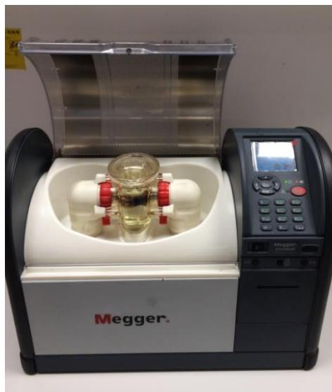
Slika 3.3.6.1. Uređaj za mjerjenje probojnog napona
