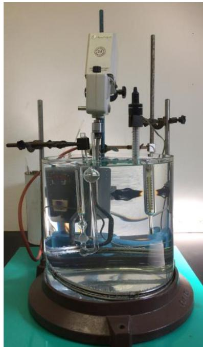
Slika 3.3.1.1. Aparatura za mjerjenje viskoznosti
