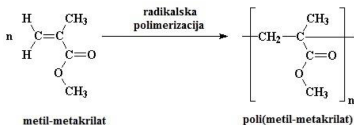
Slika 2.2.3. Dobivanje poli(metil-metakrilata) iz monomera 14
