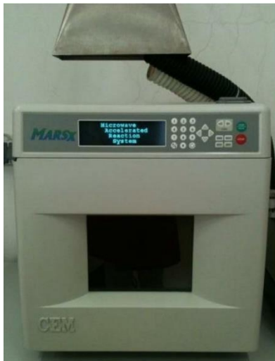
Slika 7. Uređaj za mikrovalnu digestiju
