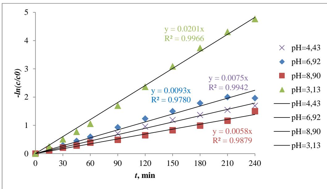
**Slika 8.7.** Utjecaj početne pH vrijednosti na fotokatalitičku razgradnju imidakloprida pri koncentraciji fotokatalizatora od 0,5 g/L UVC-TiO<sub>2</sub> P25. Testiranje eksperimentalnih rezultata na prepostavljeni model
