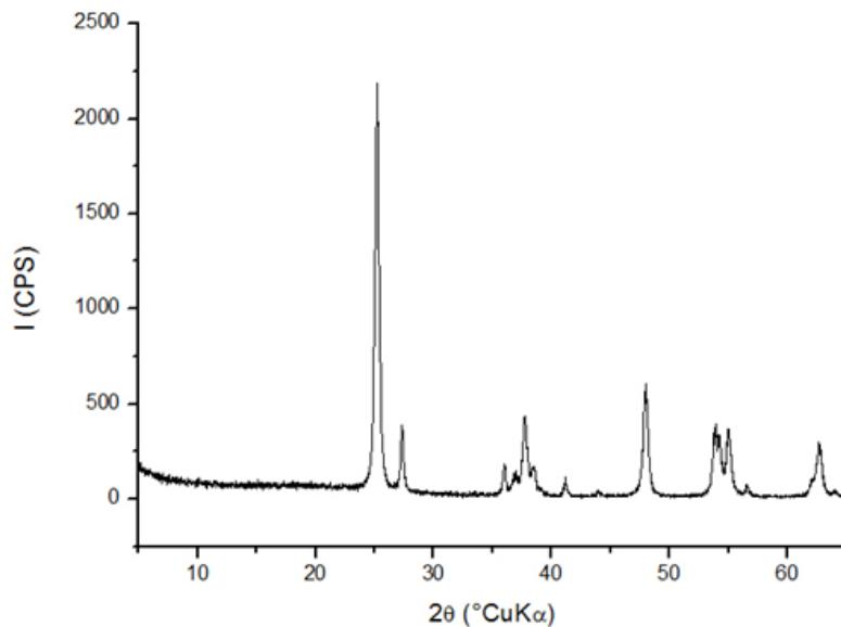
**Slika 4.2.** XRD UVC-TiO<sub>2</sub> (TiO<sub>2</sub> P25 tretiran UVC zračenjem)
