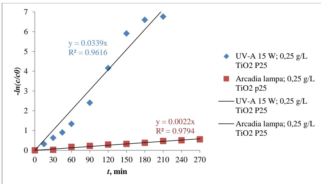
**Slika 8.6.** Utjecaj lampi UV-A 15 W i Arcadia 8 W na fotokatalitičku razgradnju 0,25 g/L TiO<sub>2</sub> P25. Testiranje eksperimentalnih rezultata na prepostavljeni model
