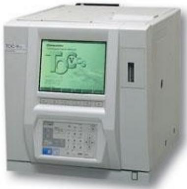
**Slika 3.4.**TOC-V<sub>CSN</sub> analizator (Shimadzu)
