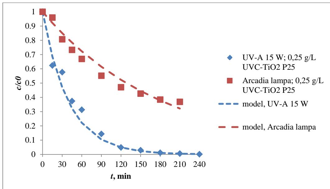
**Slika 4.8.** Utjecaj intenziteta UV zračenja primijenjenih lampi (UV-A 15W i *Arcadia* 8 W) na fotokatalitičku razgradnju imidakloprida (0,25 g/L UVC-TiO<sub>2</sub> P25)
