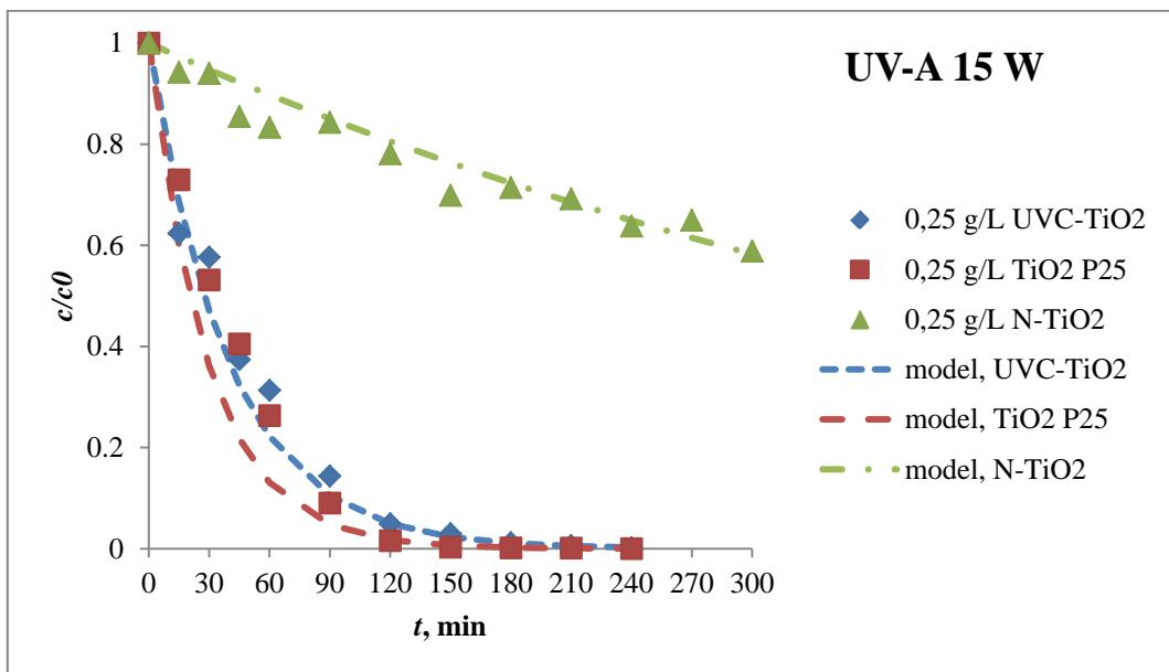
**Slika 4.7.** Usporedba katalizatora(UVC- $\text{TiO}_2$  P25;  $\text{TiO}_2$  P25; N- $\text{TiO}_2$ ) pri istim uvjetima razgradnje imidakloprida (radni uvjeti: $c_{10}=0,25\text{ g/L}$ ,  $T=30^\circ$ ,  $Q_R=1,4\text{ L/min}$  ), uz primjenu UV-A 15 W lampe
