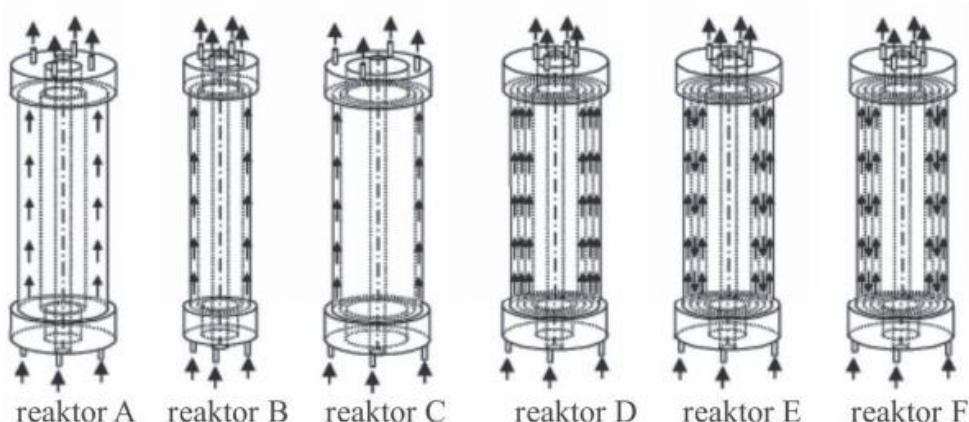
**Slika 2.6. Usporedba različitih izvedbi anularnih fotokatalitičkih reaktora. A) anularni reaktor za velika vremena zadržavanja, B) i C) anularni reaktor za mala vremena zadržavanja, D) višecijevni anularni reaktor s paralelnim tokom, E) i F) višecijevni anularni reaktor sa serijskim tokom**
