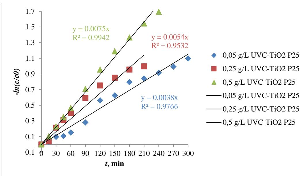
**Slika 8.2.** Utjecaj koncentracije katalizatora (UVC-TiO<sub>2</sub> P25 0,05-0,5 g/L) na fotokatalitičku razgradnju imidakloprida. Testiranje eksperimentalnih rezultata na pretpostavljeni model
