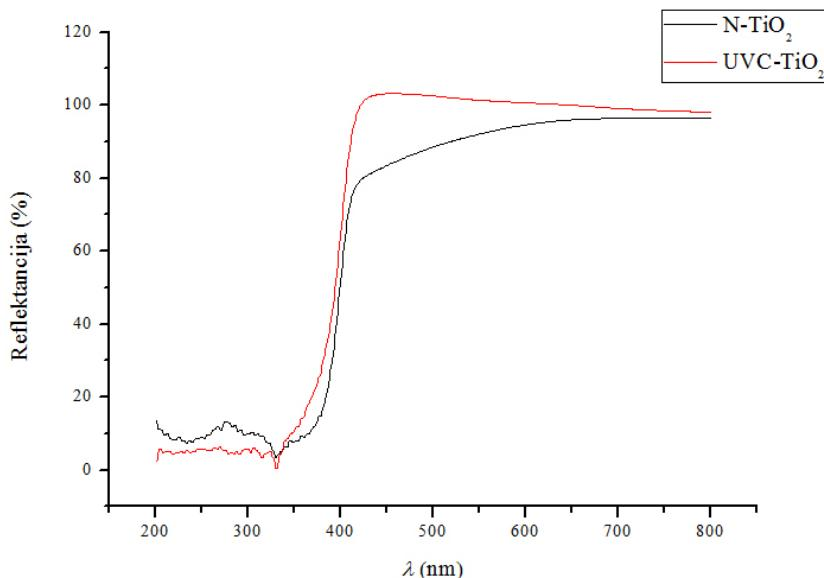
**Slika 4.3.** Usporedni prikaz UV/VIS spektara N-TiO<sub>2</sub> i UVC-TiO<sub>2</sub>
