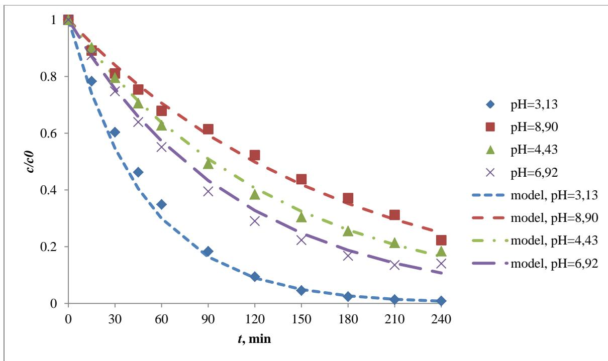
**Slika 4.10.** Utjecaj početne pH vrijednosti na fotokatalitičku razgradnju imidakloprida pri koncentraciji UVC-TiO<sub>2</sub> P25 fotokatalizatora od 0,5 g/L
