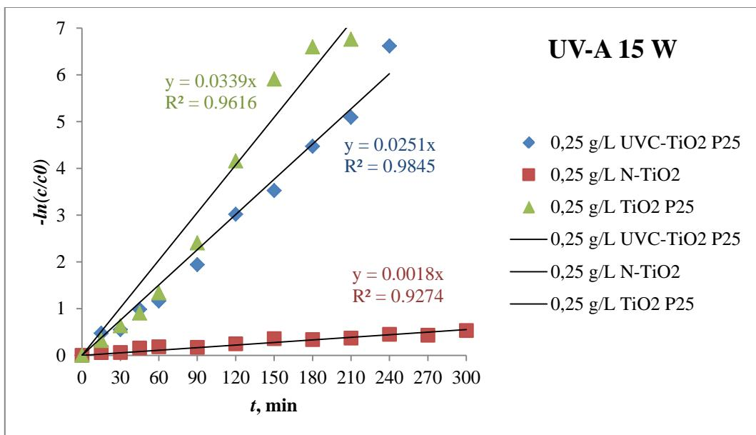
**Slika 8.4.** Usporedba katalizatora ( $\text{UVC-TiO}_2 \text{ P25}$ ;  $\text{TiO}_2 \text{ P25}$ ;  $\text{N-TiO}_2$ ) pri istim uvjetima razgradnje imidakloprida (radni uvjeti:  $c_{10}=0,25 \text{ g/L}$ ,  $T=30^\circ\text{C}$ ,  $Q_R=1,4 \text{ L/min}$ ) UV-A 15 W.
