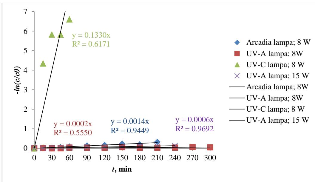
**Slika 8.8.** Fotolitička razgradnja imidakloprida uz 4 različita izvora zračenja (Arcadia 8 W, UV-A 8 W, UV-C 8 W, UV-A 15 W). Testiranje eksperimentalnih rezultata na prepostavljeni model
