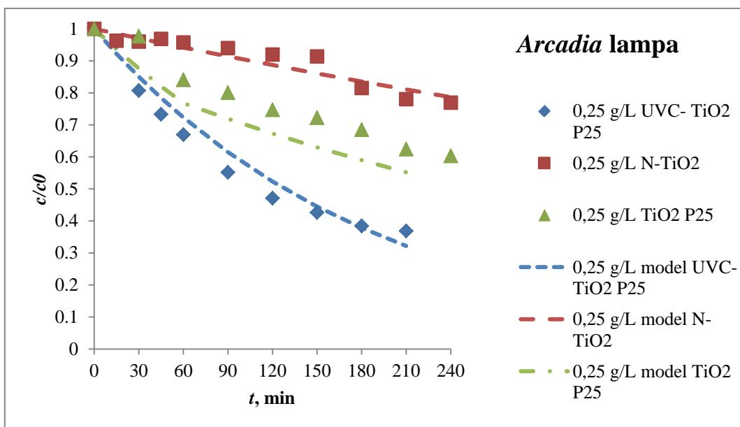
**Slika 4.6.** Usporedba katalizatora (UVC-TiO<sub>2</sub> P25; TiO<sub>2</sub> P25; N-TiO<sub>2</sub>) pri istim uvjetima razgradnje imidakloprida (radni uvjeti:  $c_{10}=0,25 \text{ g/L}$ ,  $T=30^\circ$ ,  $Q_R=1,4 \text{ L/min}$  ), uz primjenu *Arcadia* lampe (simulirano Sunčev zračenje)
