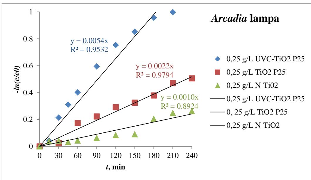
**Slika 8.3.** Usporedba katalizatora (UVC-TiO<sub>2</sub> P25; TiO<sub>2</sub> P25; N-TiO<sub>2</sub>) pri istim uvjetima razgradnje imidakloprida (radni uvjeti:  $c_{I0}=0,25$  g/L,  $T=30$  °C,  $Q_R=1,4$  L/min) Arcadia lampa 8 W. Testiranje eksperimentalnih rezultata na pretpostavljeni model
