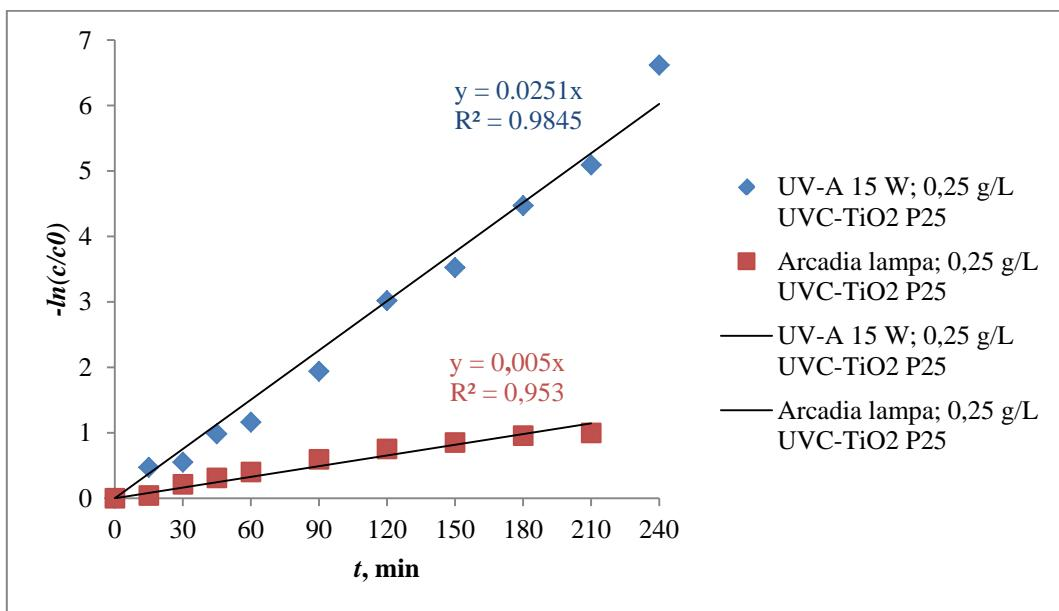
**Slika 8.5.** Utjecaj lampi UV-A 15 W i Arcadia 8 W na fotokatalitičku razgradnju 0,25 g/L UVC-TiO<sub>2</sub> P25. Testiranje eksperimentalnih rezultata na prepostavljeni model.
