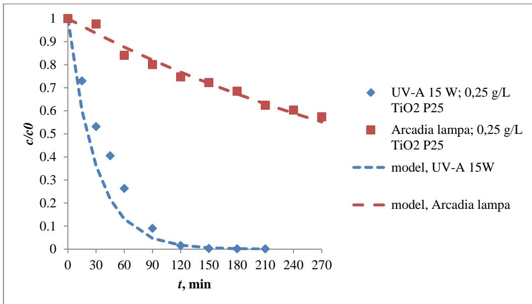
**Slika 4.9.** Utjecaj intenziteta UV zračenja primjenjenih lampi (UV-A 15 W i Arcadia 8 W) na fotokatalitičku razgradnju imidakloprida (0,25 g/L TiO<sub>2</sub> P25)
