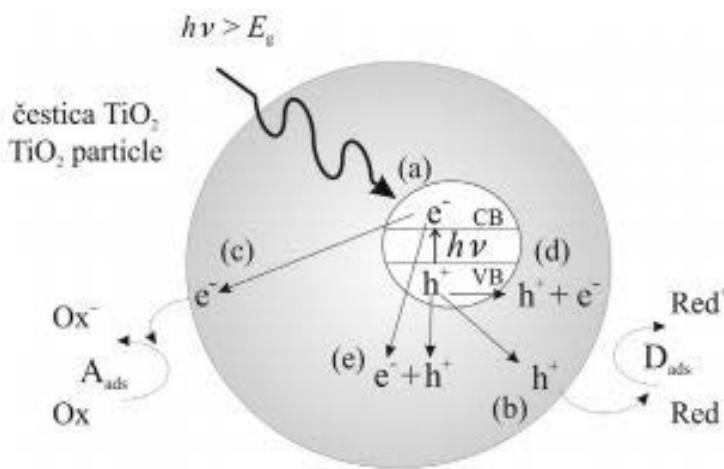
**Slika 2.1.** Glavni proces u čestici poluvodiča  $TiO_2$ : a) nastajanje para elektron-šupljina, b) oksidacija adsorbirane molekule  $D$ , c) redukcija adsorbirane molekule  $A$ , d) rekombinacija na površini čestice, i e) rekombinacija u unutrašnjosti čestice
