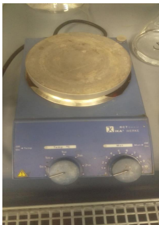
Slika 9. RCT basic magnetska miješalica (Proizvođač IKA-werke)
