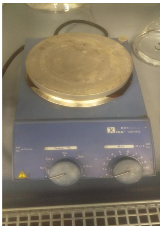
Slika 9. RCT basic magnetska miješalica (Proizvođač IKA-werke)
