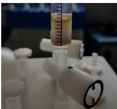
Slika 3.22. Sloj bojila na koloni vidljiv nakon propuštanja uzorka diesela
