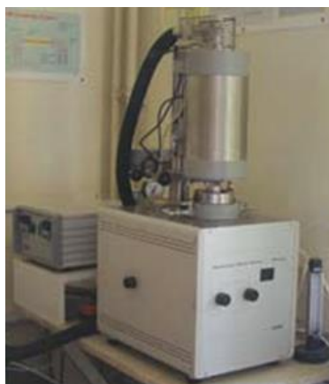
Slika 3.12. Simultani DTA/TGA analizator „Netzsch STA 409“
