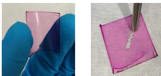
Slika 4.5: Mehaničke karakteristike tankoslojnih filmova; savitljivost i otpornost
