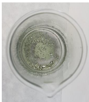
Slika 12. Prikaz dobivenog Ag-PAA taloga nakon sušenja.
