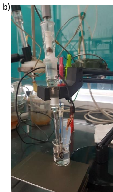
Slika 11. Prikaz a) potenciostata; b) troelektrodne ćelije korištene pri potenciostatskim mjerenjima.
