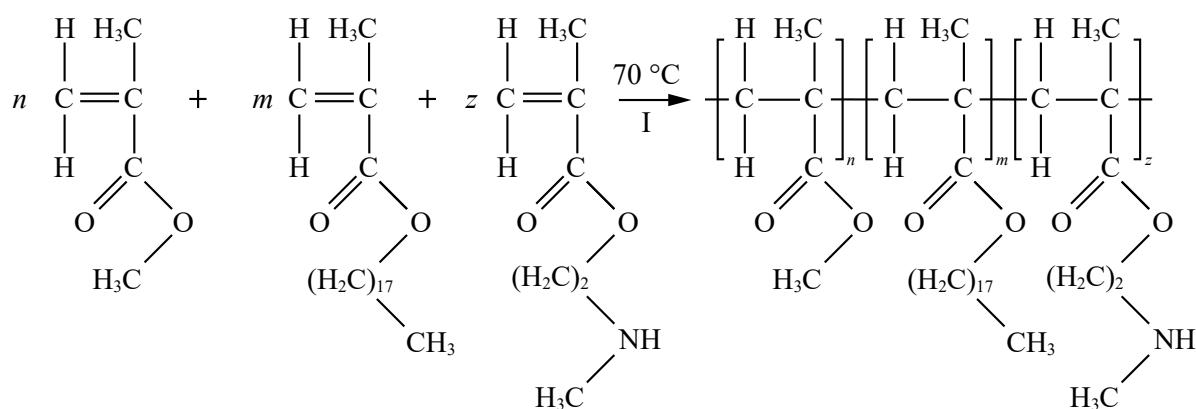
**Slika 21** – Prikaz provedene reakcije terpolimerizacije MMA-TBAEMA-ODMA.
