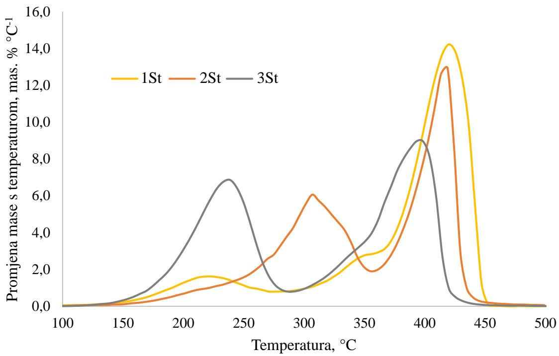
Slika 35 – Diferencijalne termogravimetrijske krivulje pokusa 1St, 2St i 3St
