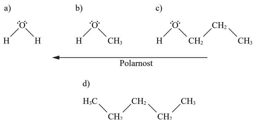
**Slika 18** – Neotapala korištena za pretaloživanje: a) voda, b) metanol, c) propanol, d) pentan.
