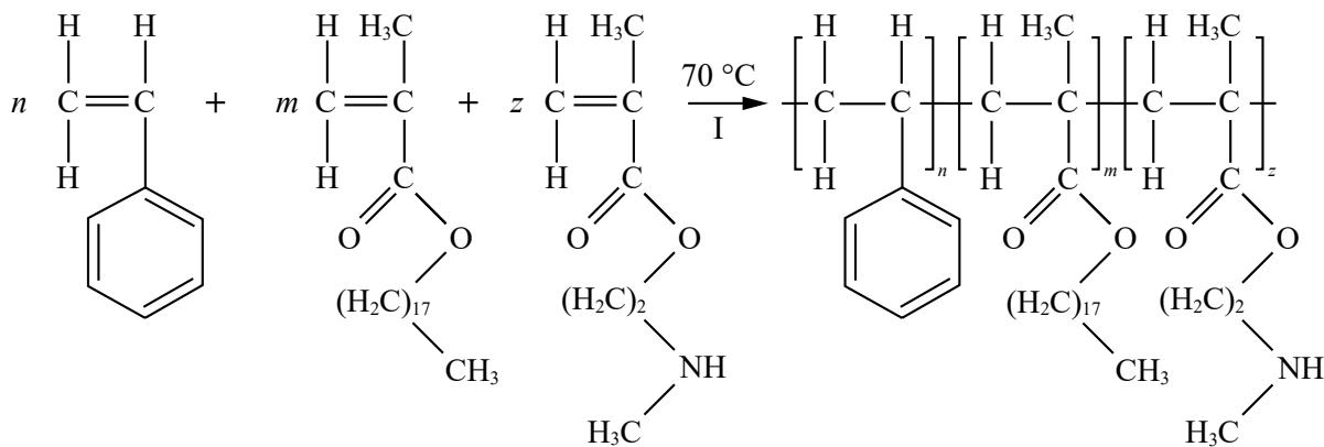
**Slika 22** – Prikaz provedene reakcije terpolimerizacije St-TBAEMA-ODMA.
