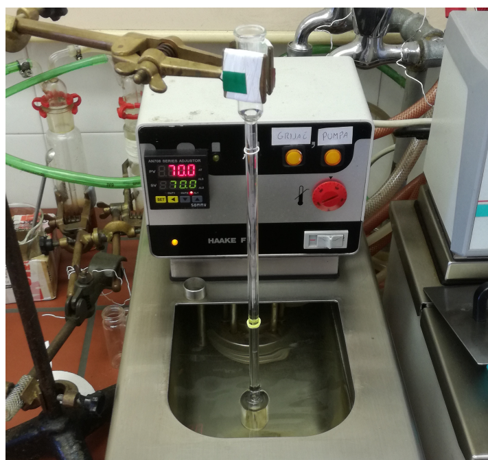
Slika 19 – Dilatometar grijan u uljnoj kupelji.
