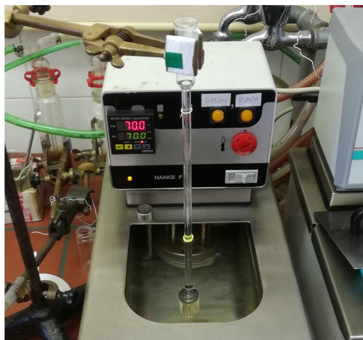
**Slika 19 – Dilatometar grijan u uljnoj kupelji.**
