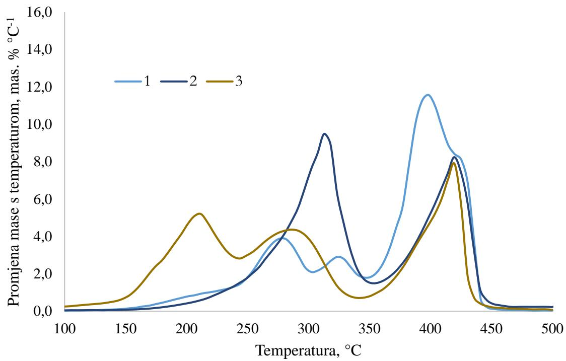
Slika 33 – Diferencijalne termogravimetrijske krivulje za pokuse 1, 2 i 3
