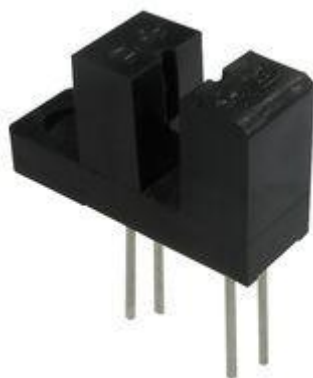
Slika 18. Fotoelektrićni element, KTIR 0421 DS. Cijena 12 HRK.
