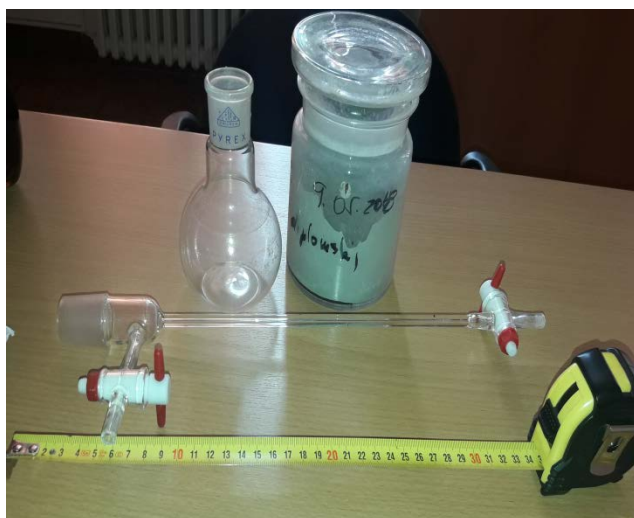
Slika 13. Shematski prikaz piknometrijskog mjerenja kemijskog skupljanja (lijevo), te dijelovi aparature s ubrušenim čepom i teflonskim pipcima za lakše odzračivanje.
