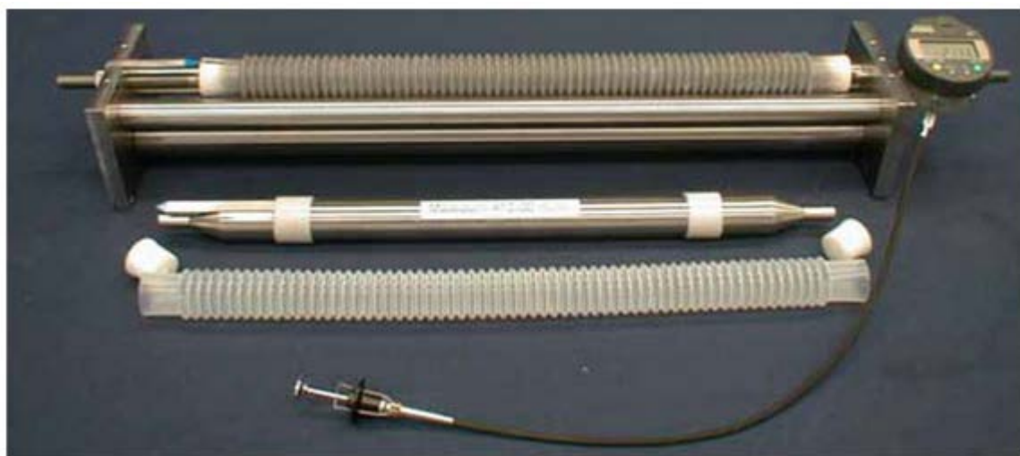
Slika 10. Aparatura za mjerenje kemijskog skupljanja cementnih pasti, prema ASTM C1698.
