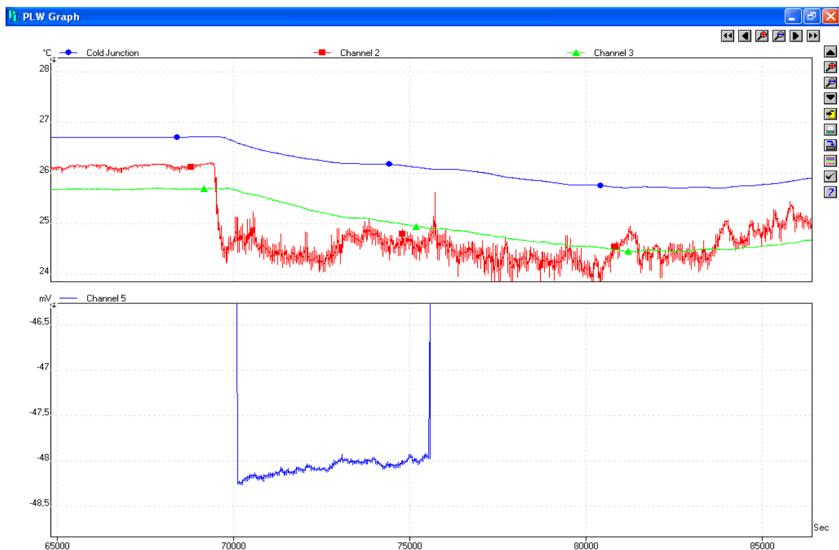
Slika 27. Detalj mjerenja od 70000 do 75500 s, pri konstantnoj masi, no uz promjenu temperature parafina veću od oko 0.7 °C.
