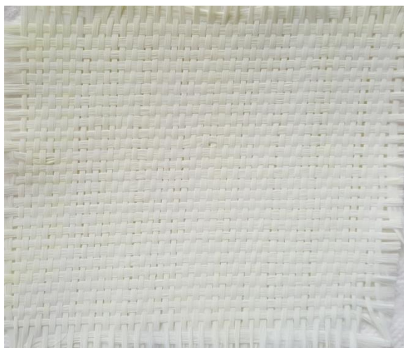
Slika 3.1. Imobilizirani sloj TiO_2 na staklenom platnu
