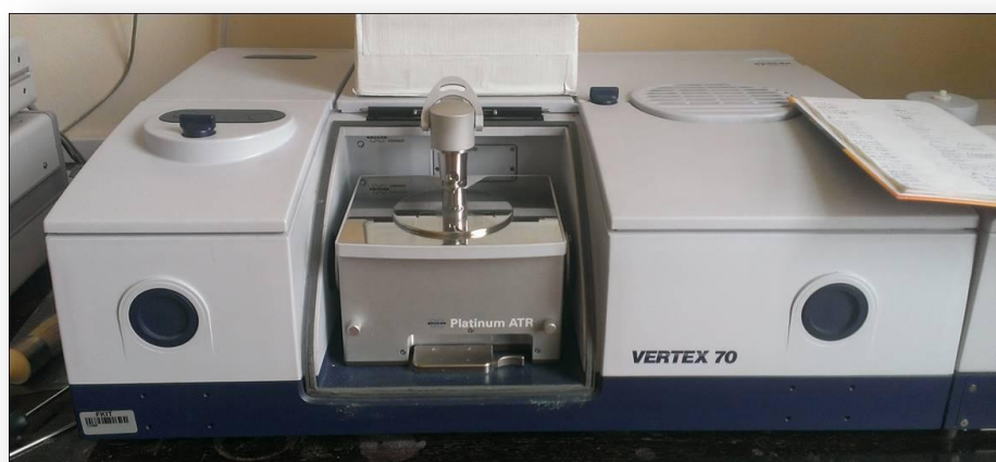
Slika 3.14. Fotografija FTIR spektrofotometra Vertex 70 s platinastim detektorom (Bruker, Billerica, SAD).
