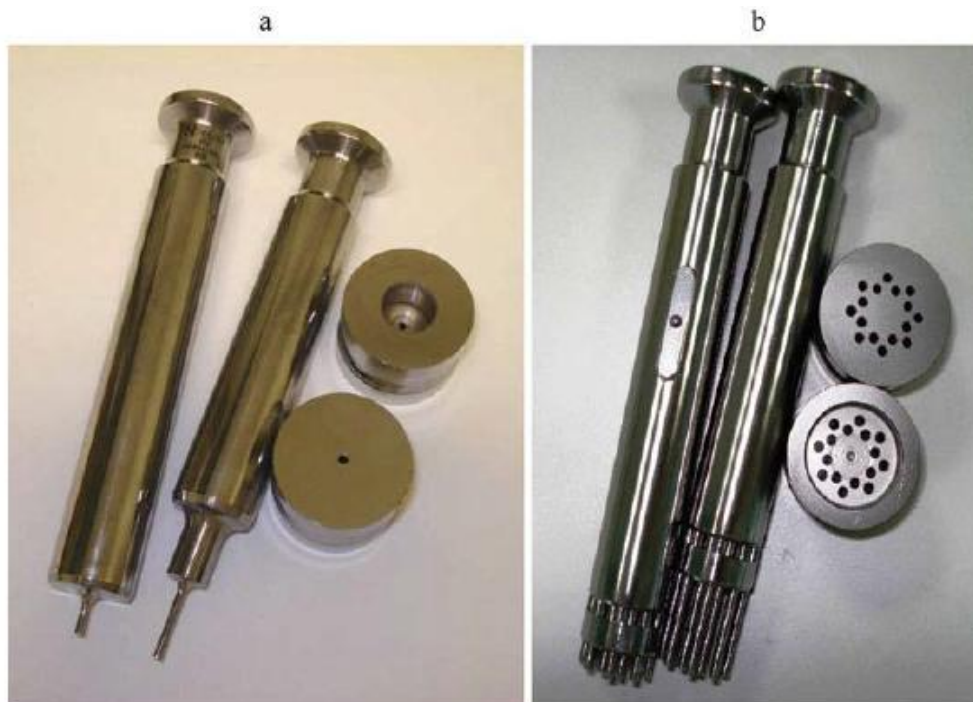
Slika 2.3. Jednostruki (a) i višestruki (b) pečati za uređaj za tabletiranje.
