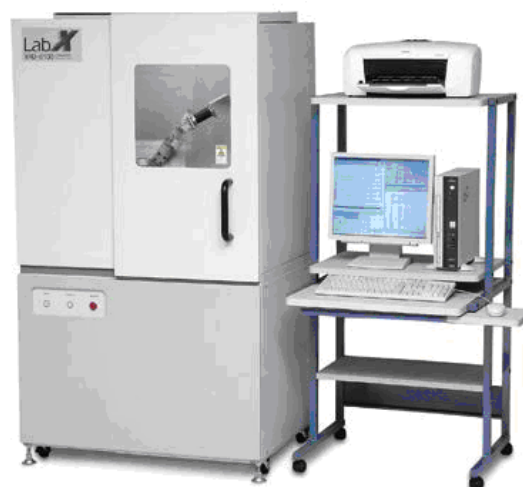
Slika 3.12. Fotografija uređaja za rendgensku difrakciju praha XRD-6300 (Shimadzu, Kyoto, Japan).
