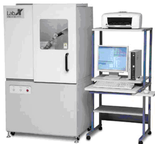
Slika 3.12. Fotografija uređaja za rendgensku difrakciju praha XRD-6300 (Shimadzu, Kyoto, Japan).
