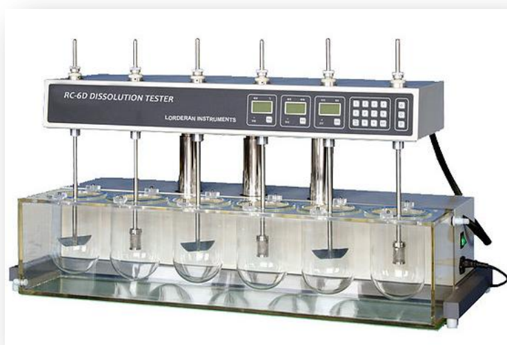
Slika 3.18. Uređaj za ispitivanje brzine otpuštanja djelatne tvari RC-6D (Zhengzhou Nanbei Instrument, Henan, NR Kina).
