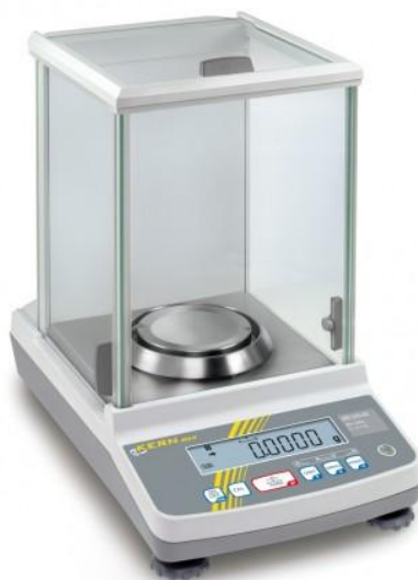
Slika 3.15. Analitička vaga KERN ALJ 220-4NM (KERN, Balingen, SR Njemačka).
