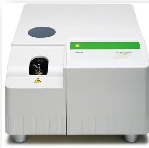
Slika 3.13. Fotografija diferencijalnog pretražnog kalorimetra Mettler Toledo 822 e (Mettler Toledo GmbH, Greifensee, Švicarska).
