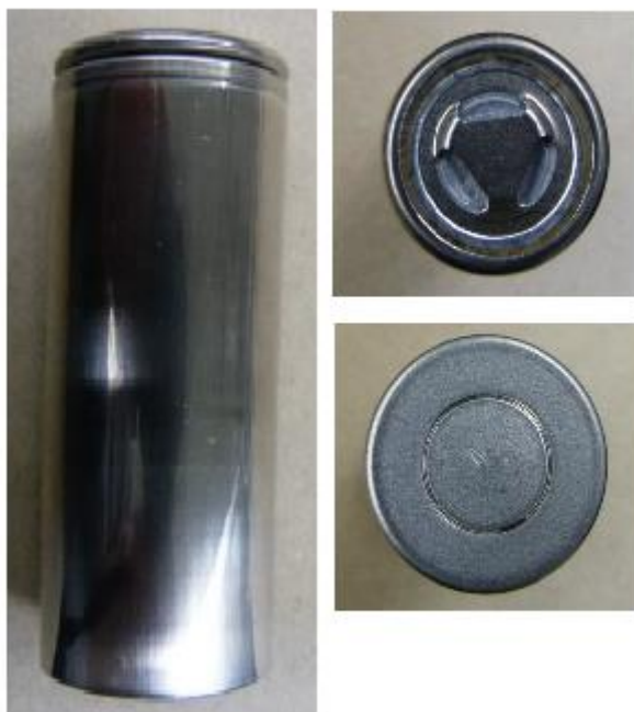
Slika 26. Fotografije LG M50 litij-ionskog galvanskog članka koji je korišten u mjerenju [29].
