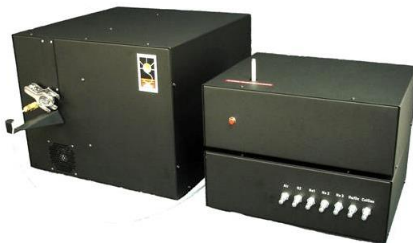
Slika 26. Analizator ugljika u lebdećim česticama [64]
