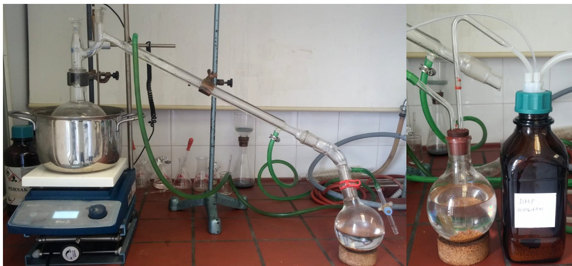
Slika 8. Aparatura za pročišćavanje DMF-a (lijevo) i boca za pohranu destilata (desno) (izvor: vlastite fotografije)
