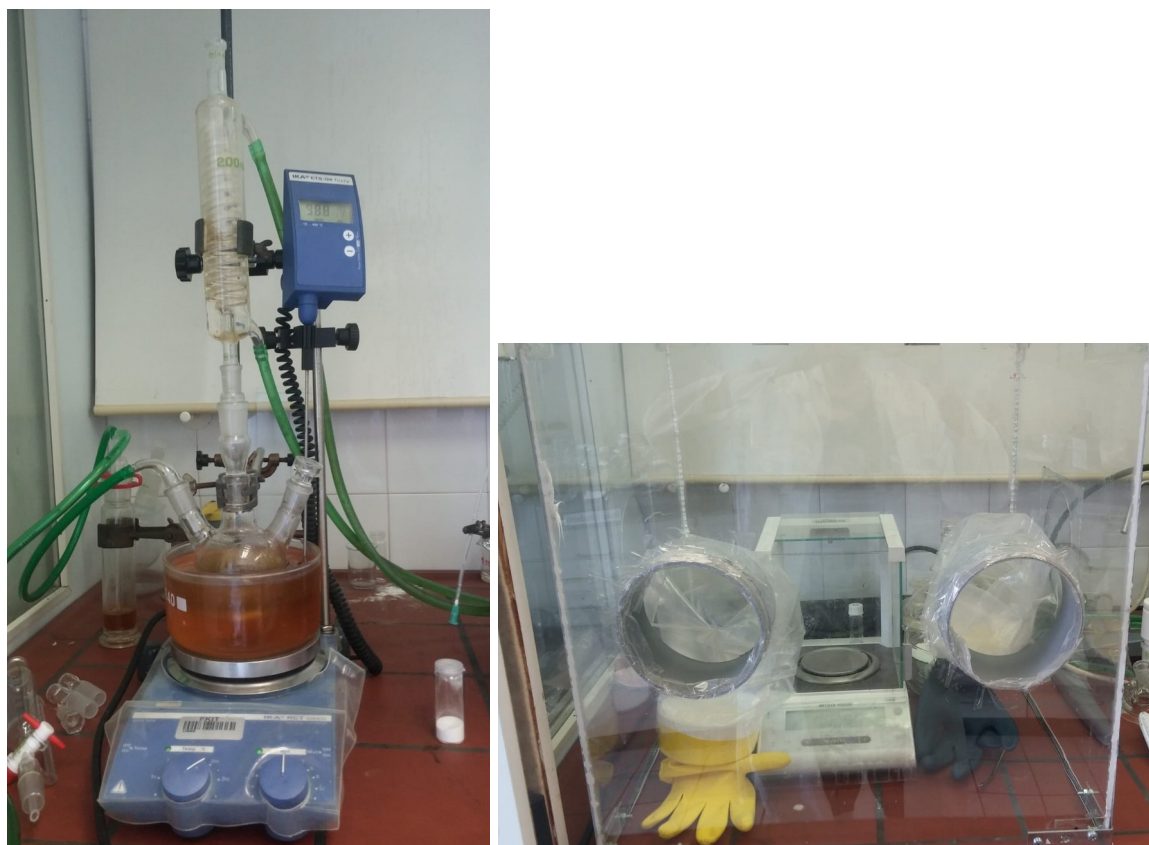
Slika 9. Aparatura potrebna za otapanje celuloze (lijevo) te prostor za vaganje celuloze u inertnoj atmosferi (desno) (izvor: vlastite fotografije autora)
