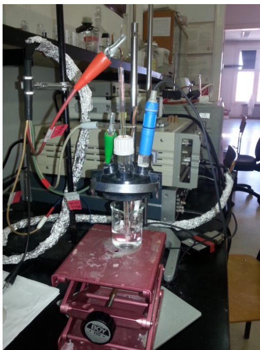
Slika 3.8. Prikaz aparature za cikličku voltametriju
