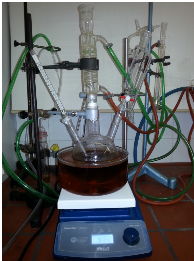
Slika 3.2. Redukcija grafen oksida u grafen
