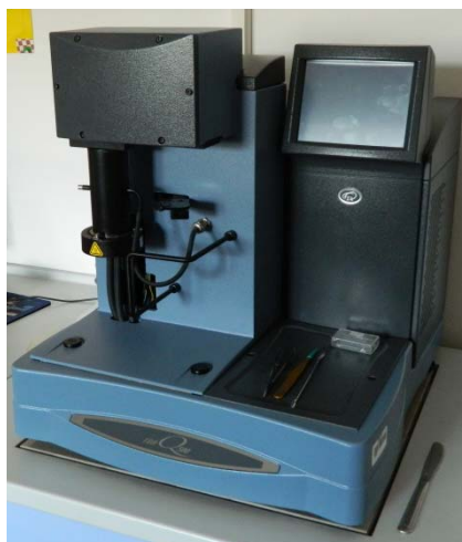
Slika 3.7. Termogravimetar TA Instruments Q500
