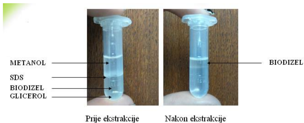
Slika 24. Uzorak biodizela prije i nakon ekstrakcije u mikroseparatoru
