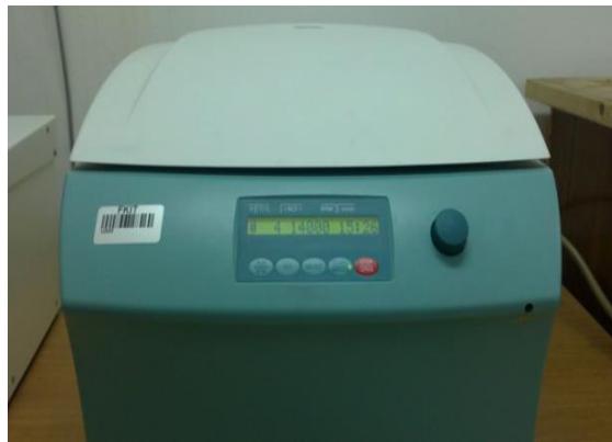
Slika 6. Centrifuga Hettich Universal 320R
