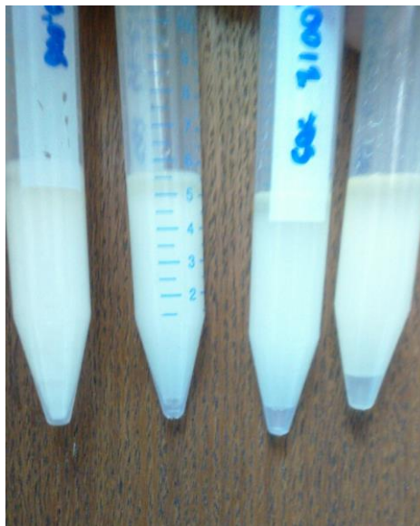
Slika 17. Raslojavanje faza u uzorcima sa SDSom
