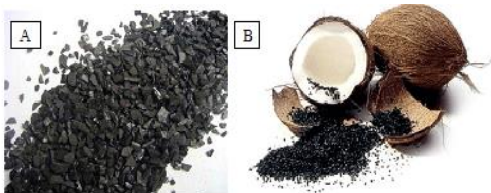
Slika 6. A: Komercijalni granularni aktivni ugljen [46] B: Granularni aktivni ugljen proizveden od kokosove ljuske [47]
