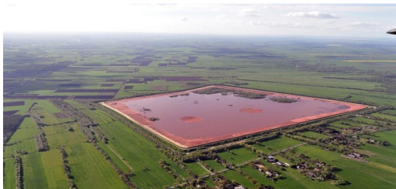
Slika 11. Bazen za odlaganje crvenog mulja u Njemačkoj [78]
