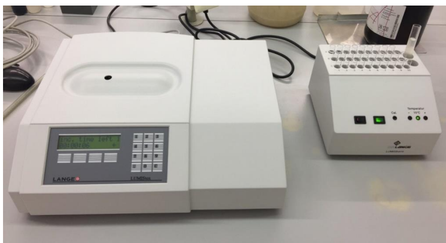
Slika 23. Instrument za provedbu toksičnosti LUMIStox 300 s termostatskim blokom LUMIStherm
