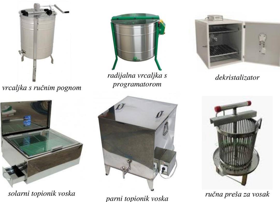
**Slika 5.** Prikaz pčelarske opreme za vrcanje, dekrystalizaciju, topljenje i prešanje voska<sup>10</sup>
