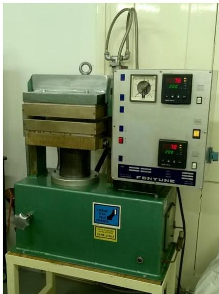
Slika 17. Hidraulička preša
