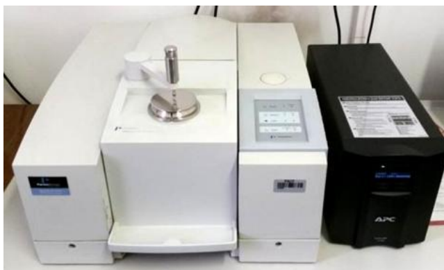
Slika 18. FTIR spektrometar, Perkin Elmer Spectrum One Spectrometer s ATR sustavom
