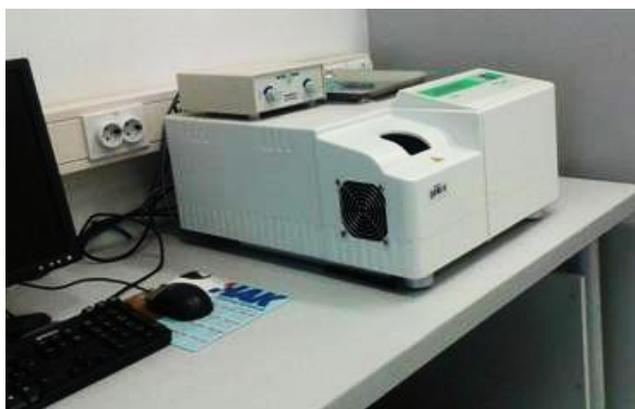
Slika 20. DSC uređaj *Mettler Toledo DSC 823e*
