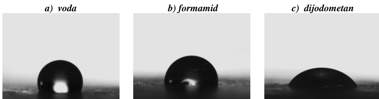
Slika 30. Kapljice testnih kapljevin na pločici komercijalnog pčelinjeg voska BW - žuti R
