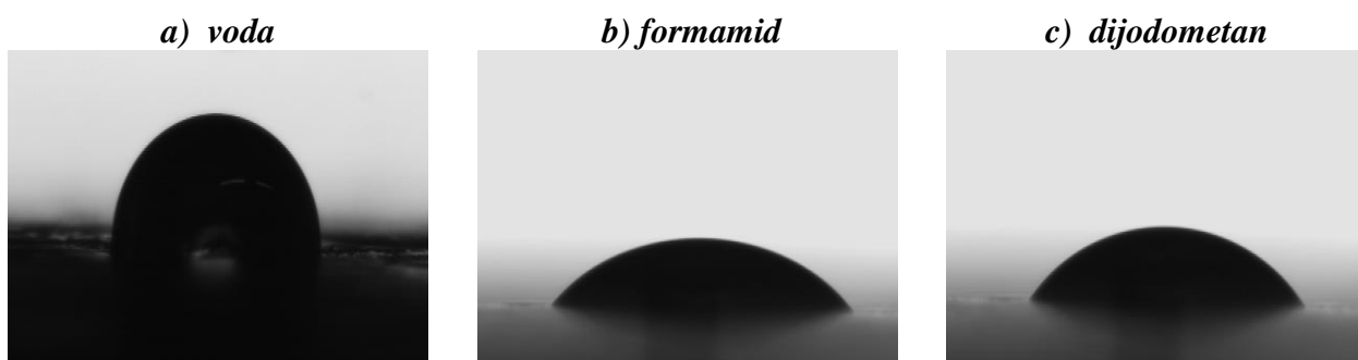
Slika 28. Kapljice testnih kapljevina na pločici domaćeg pčelinjeg voska BW-žuti D
