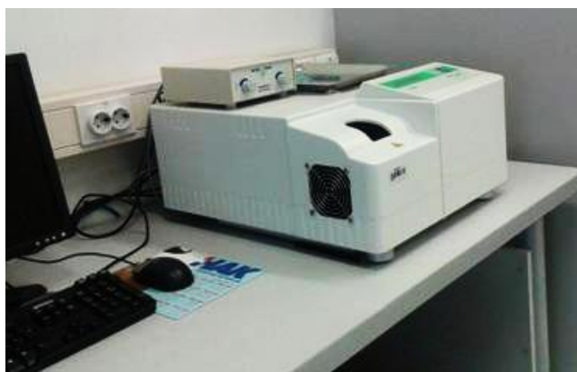
Slika 20. DSC uređaj Mettler Toledo DSC 823e
