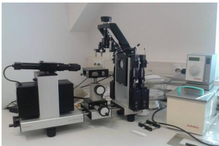
Slika 19. DataPhysics OCA 20 Instruments uređaj za mjerenje kontaktnog kuta (goniometar)
