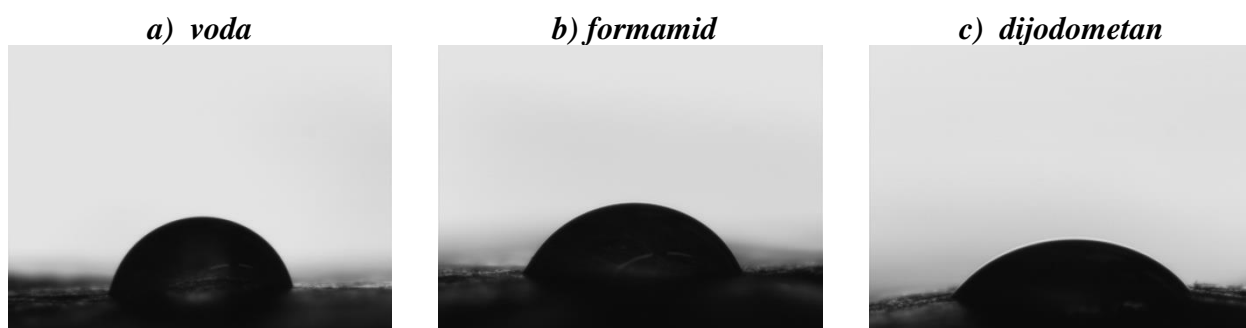
Slika 29. Kapljice testnih kapljevina na pločici domaćeg pčelinjeg voska BW - smeđi D
